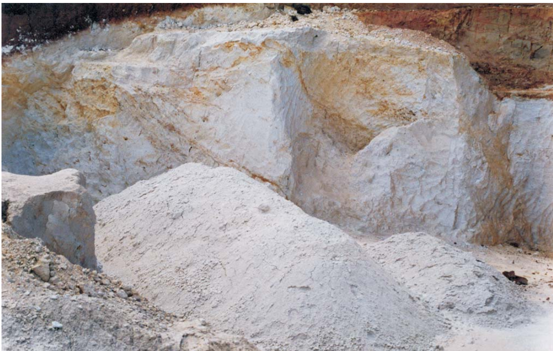
Antapucro (caolín) - cuadrángulo de Huánuco. Vista de la cantera donde muestra un paquete tabular del material arcilloso que se explota dentro de las facies esquistosas arcillosas del Complejo metamórfico del Marañón (Precambriano).
