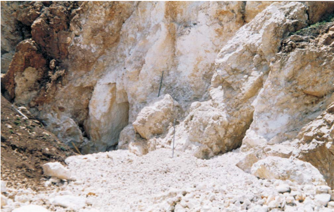
Baricel depósito (calcita) - cuadrángulo de Ambo. Se observa la estructura tabular de 20 m de potencia emplazada en las calizas del Grupo Pucará. Actualmente se explota a cielo abierto donde se aprecia el material en cancha lista para ser trasladado.
