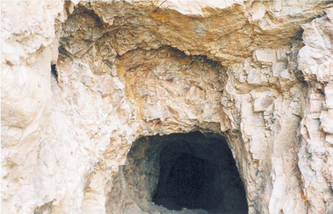
Huaracalla Socavón (Cu,Ag) - cuadrángulo de Ambo. Obsérvese la brecha mineralizada controlada por una falla que alcanza 0,40 m de potencia y está emplazada en rocas del Grupo Ambo del Carbonífero inferior. Actualmente abandonada.
