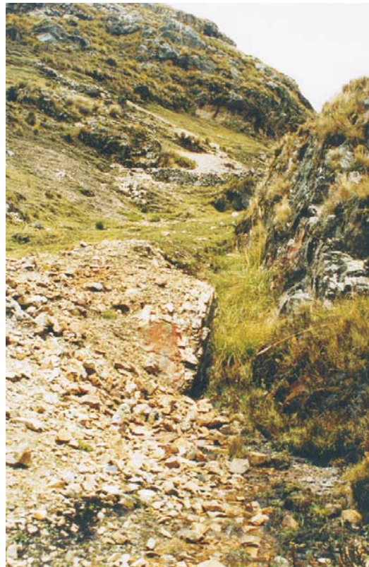
Pachachaca (Au, Ag, Pb) - cuadrángulo de Yanahuanca. Vista de una de las labores abandonadas. Interiormente se tiene una veta bien definida de 0,20 m de potencia y valores apreciables en oro. La roca/caja lo conforman areniscas del Goyllarisquizga.
