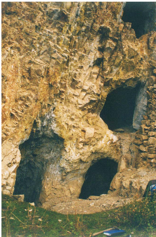
Cristo Pobre (Cu, Au) Queropalca - cuadrángulo de Yanahuanca. Veta subvertical de rumbo N 67° E y buzamiento 83° SE con una potencia de 0,30 m. Se denota la presencia de arg, py fina en pequeños cristales y hematita. Valores químicos de interés corresponde a la plata y algo de oro.
