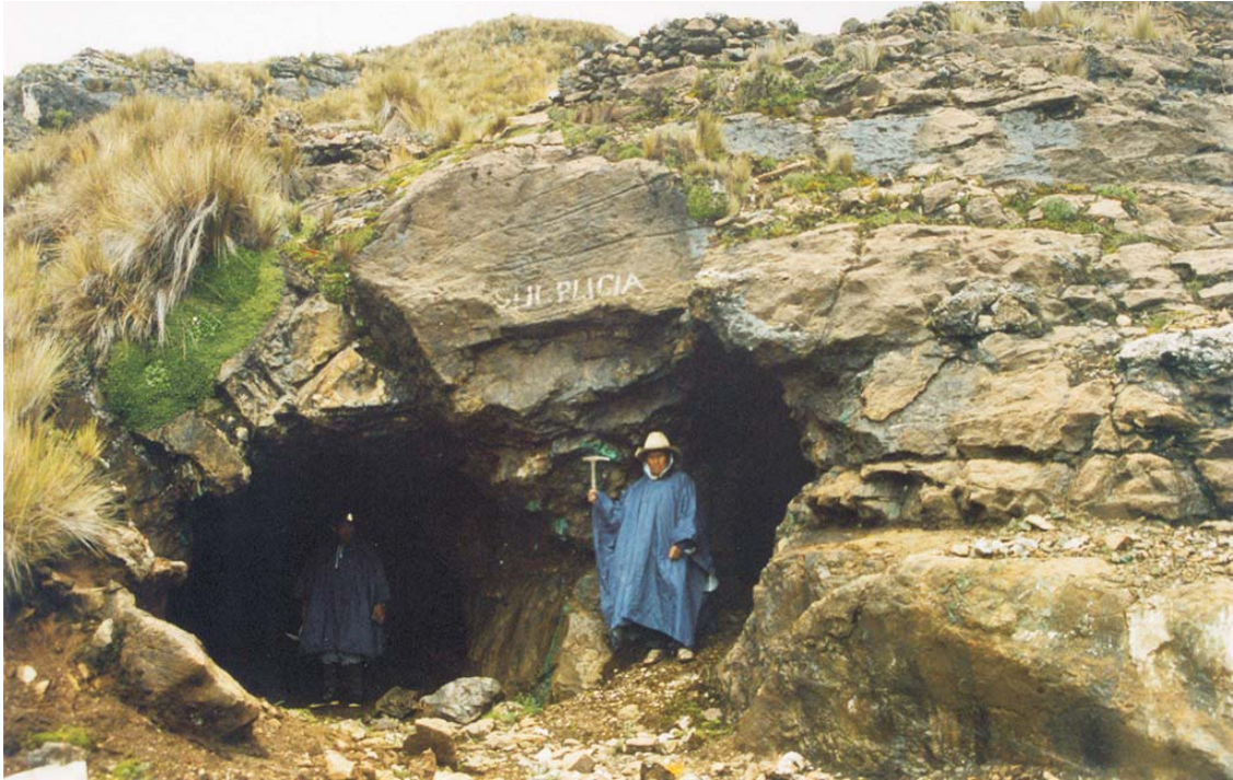
Acotambo - Manto Sulplicia (Cu, Zn) - cuadrángulo de Pomabamba. Interiormente presenta lentes hasta de 4 m de grosor conteniendo calcopirita y esfalerita. Localizados en las calizas Pucará. Fue trabajada intensamente.
