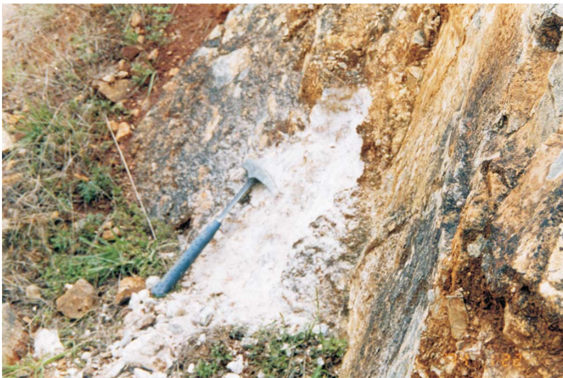
Llunco Cateo (Cu, Au, Zn) - cuadrángulo de Ambo. Vista cercana al cateo donde se tomó una muestra en una estructura en la parte brechada y cercana a la falla. La roca/caja corresponde a un intrusivo (hipabisal dacítico).
