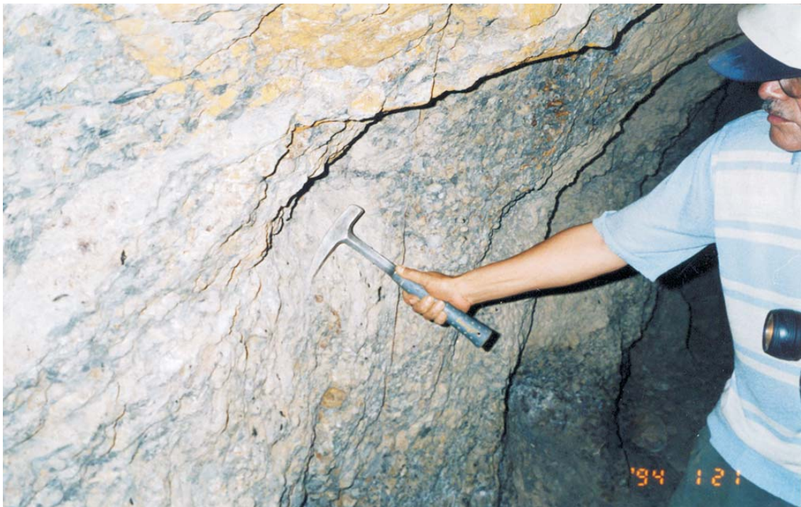
Mina Plazan (Cu,Ag,Zn) - cuadrángulo de Ambo. Vista tomada en el interior de la mina donde se puede apreciar el material brechado y silicificado. La roca/caja compuesta por sedimentos pertenece al Grupo Ambo.
