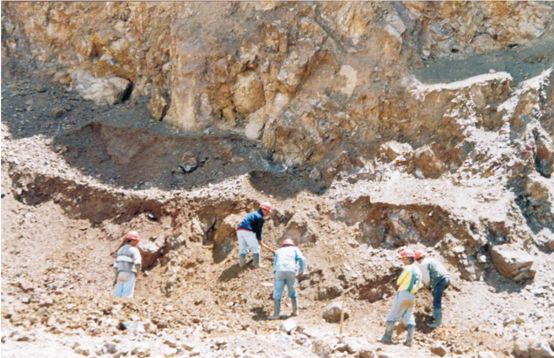
Barimayo (baritina) cuadrángulo de Ambo. Vista panorámica de la cantera donde se puede apreciar el cuerpo tabular explotado y los afloramientos calcáreos del Grupo Tarma-Copacabana. Actualmente se trabaja el tajo a pequeña escala.
