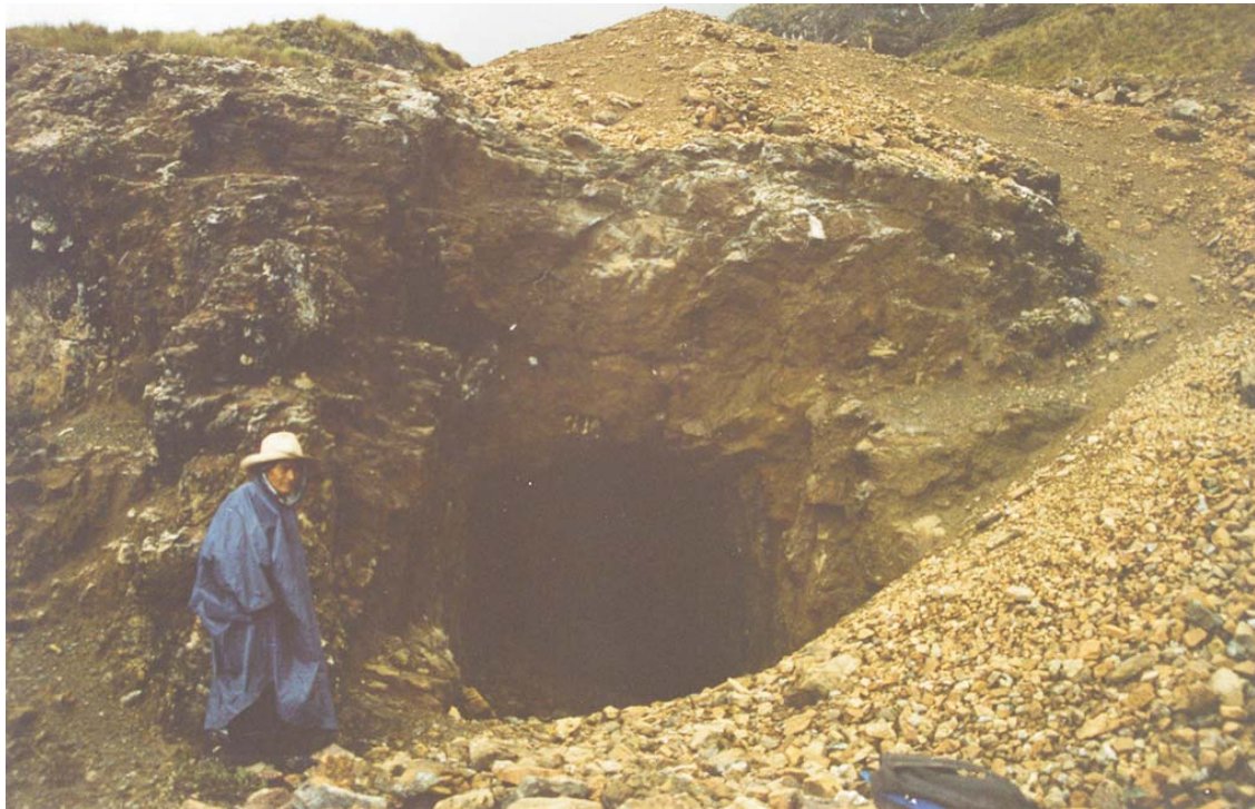
Acotambo - Manto Decia (Cu,Zn) - cuadrángulo de Pomabamba. La veta corresponde a la parte central de todo el complejo. Hay calcopirita, bornita, esfalerita y cobre gris que engloba a la pirita.
