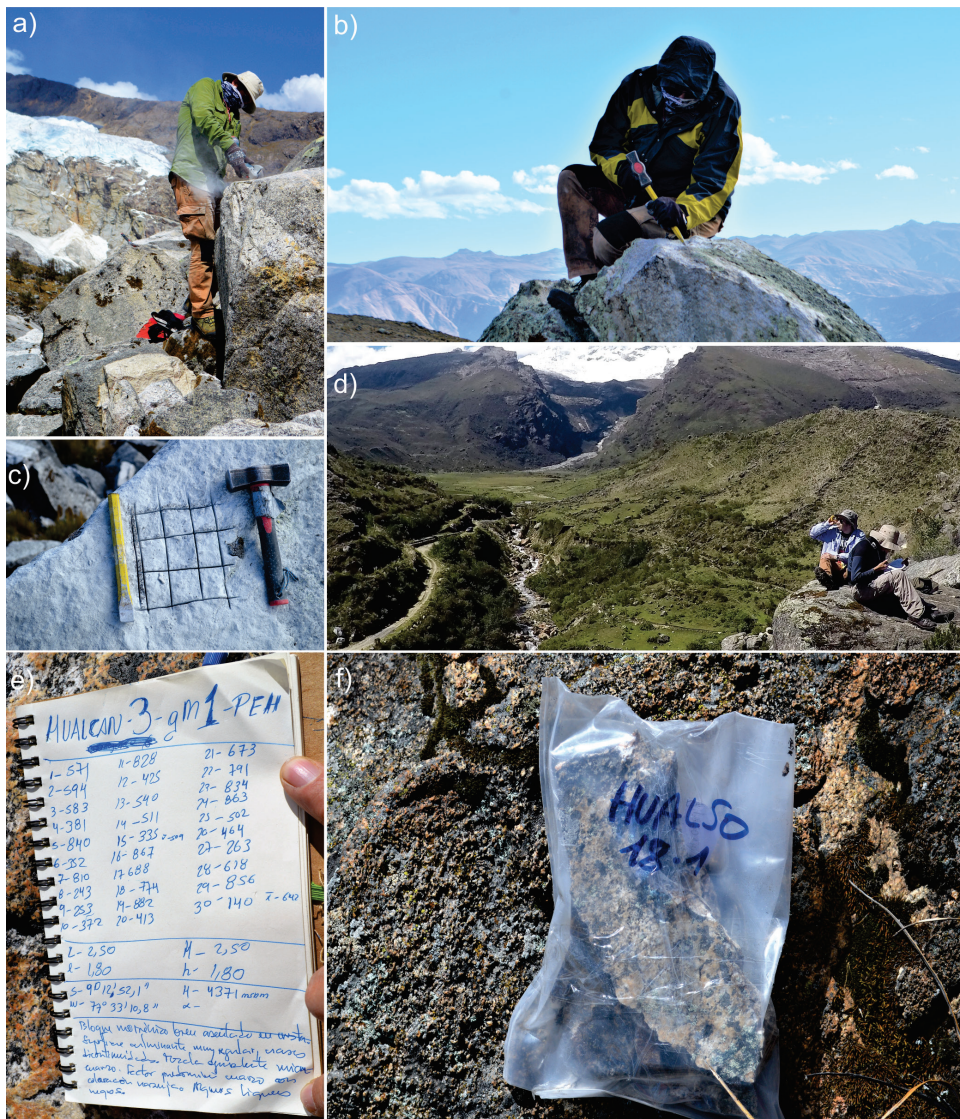
Fotografía 4.2 a) y b) muestreo de la superficie de un bloque morrénico utilizando una amoladora a baterías, una comba y cinceles; c) malla de muestreo hecha con la amoladora antes de extraer la muestra con comba y cinceles; d) mediciones de la orientación y declinación del horizonte; e) libreta de apuntes; f) empaquetamiento de una las muestras (0.5-1 kg)
