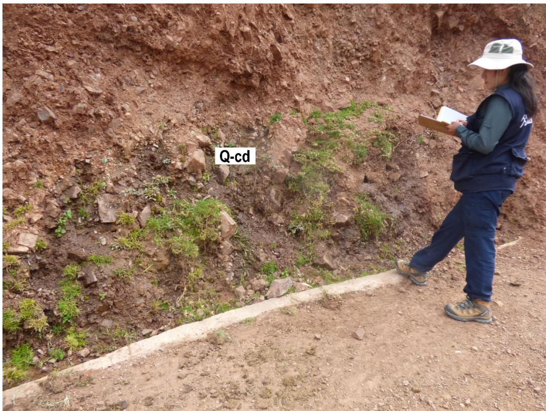
Figura 7. Depósito coluvio-deluvial compuestos por fragmentos de rocas volcánicas angulosos a subangulosos, heterométricos y envueltos en una matriz de arenas y limos, removidos por procesos de movimientos en masa antiguos.
