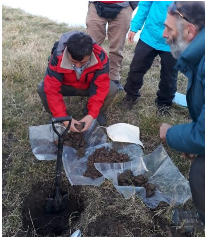
Fig. 2.2.1.4 - Muestra de Flood Plain - Argentina: Analizando las muestras de la sección superior (0-25 cm) de los tres perfiles que componen una muestra de llanura de inundación, previo al embolsado. Región pampeana, Buenos Aires, República Argentina. Foto SEGEMAR
