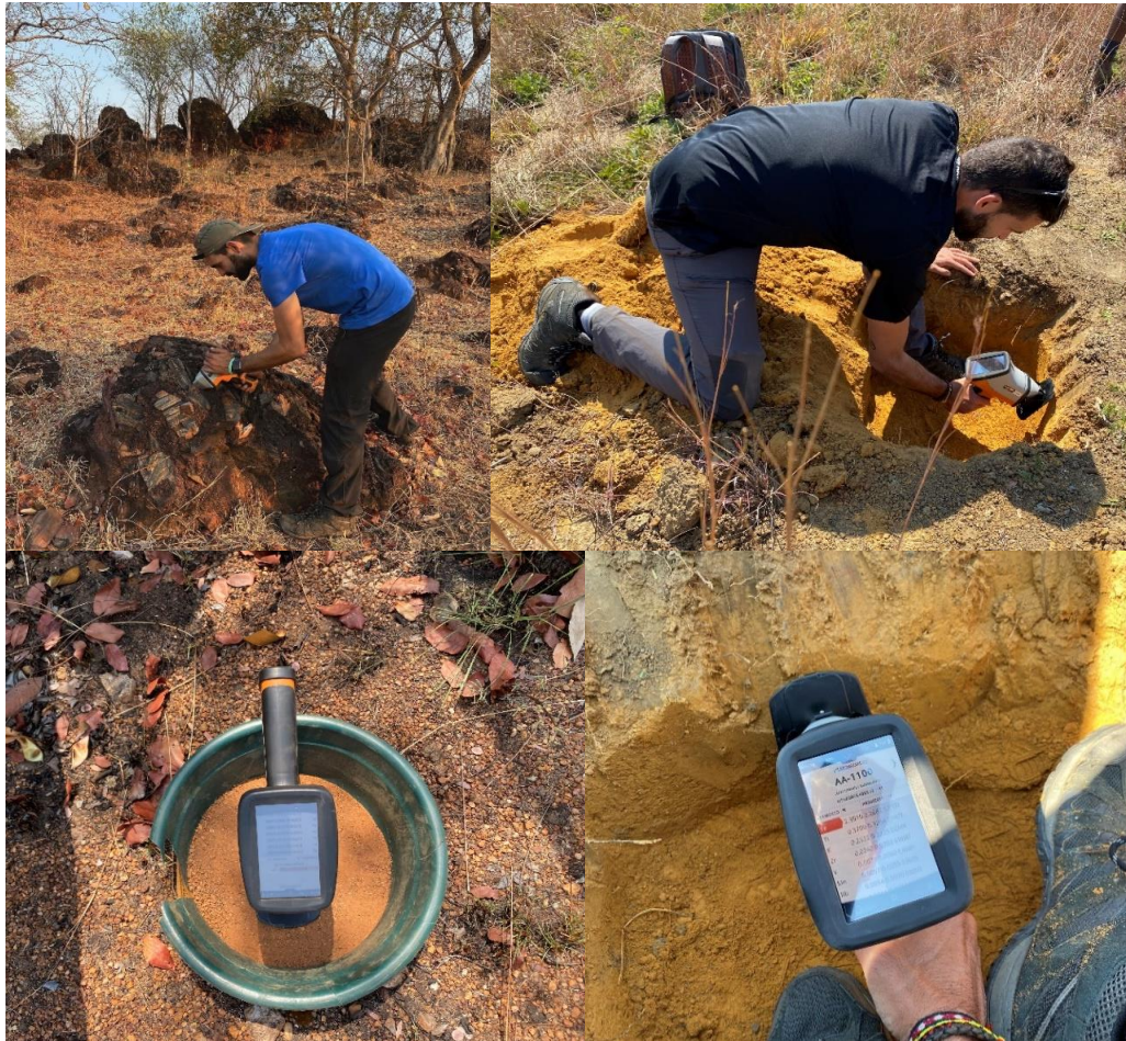
Figura 4.3. Uso de analizadores portátiles FRX en suelos y rocas (fuente: IGME, España)
