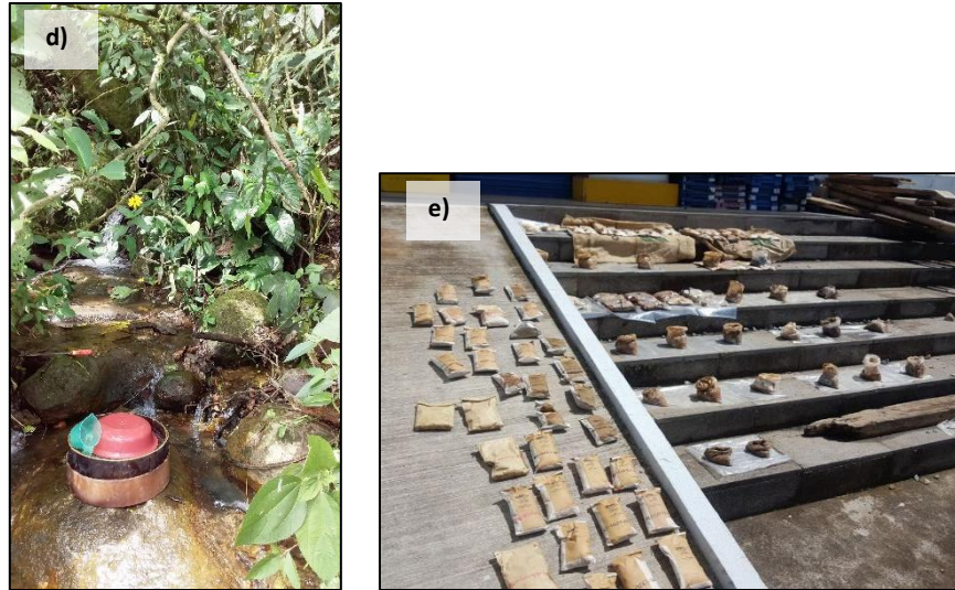
Figura 2.2.1.6. Procedimiento de toma de muestras, empaquetado y secado. a) Recolección del sedimento; b) y c) Tamizado por vía húmeda; d) Tamices y equipo de muestreo lavado luego de la toma de la muestra; e) Empaquetado y secado de muestra
