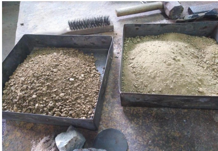
Figura 3.1.14. Muestra antes y después del pulverizado de anillos
