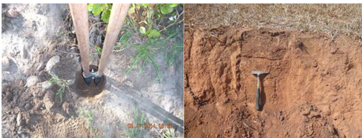
Figura 2.1.27. Colecta de suelo con barreno “boca de lobo”. Sierra verde, GO, Brasil. Perfil laterítico con desarrollo de latosuelo. Cuadrilátero Ferrífero, MG, Brasil.
