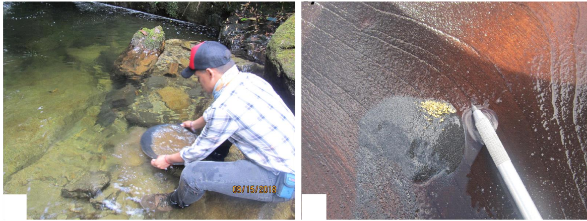
Fig. 2.2.1.10 - Obtención de concentrados de batea para la prospección geoquímica de oro en Colombia. a) Toma de muestra mediante concentrados de batea a partir del lavado de sedimentos de río. b) Producto de la concentración gravimétrica. Granos de oro y arenas negras compuestas por minerales densos.
