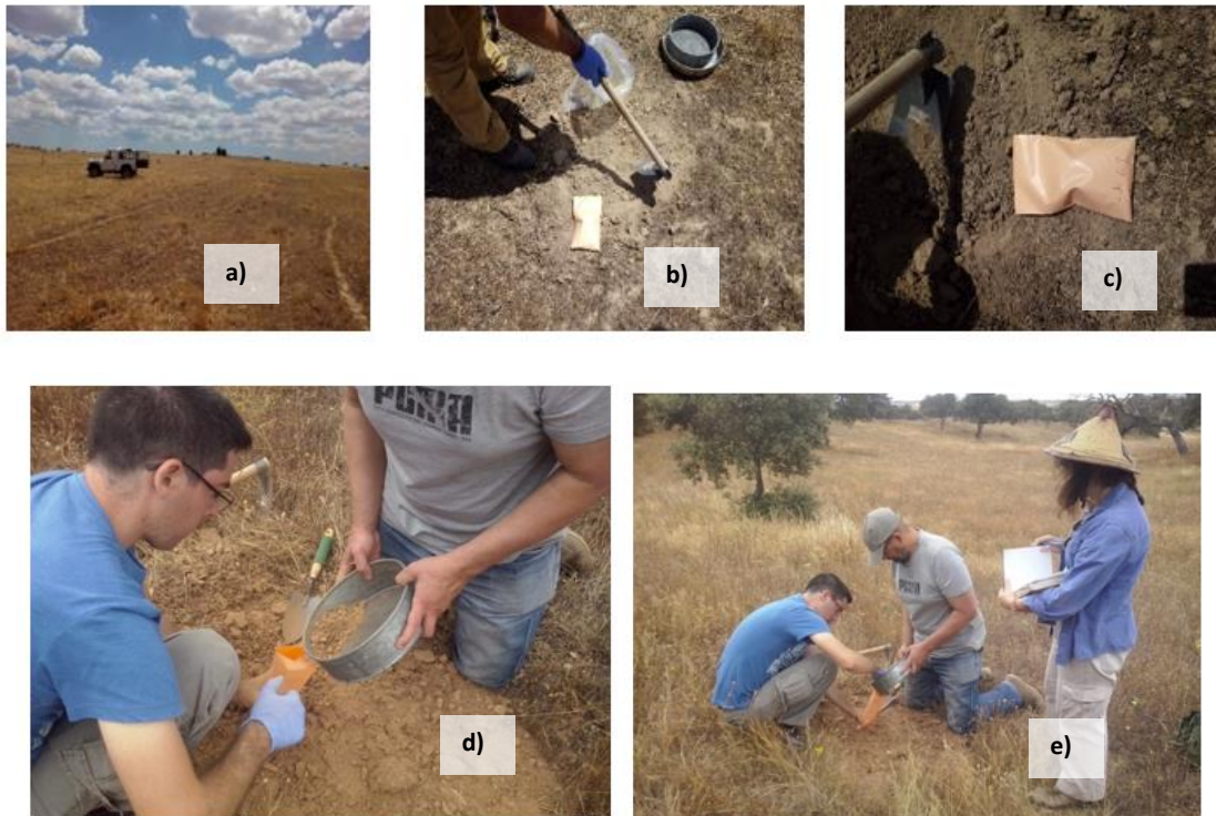
Figura 2.2.1.22 - Fotografías representativas del procedimiento de muestreo de suelo residual con fines de prospección mineral. a) Fotografía de paisaje que abarca el área a muestrear; b) sitio de muestreo con azada, tamiz con abertura de 5 mm y bolsa kraft (ejemplo de muestreo para Mobil Metal Ions - MMI) en la región minera de Neves Corvo, Alentejo
