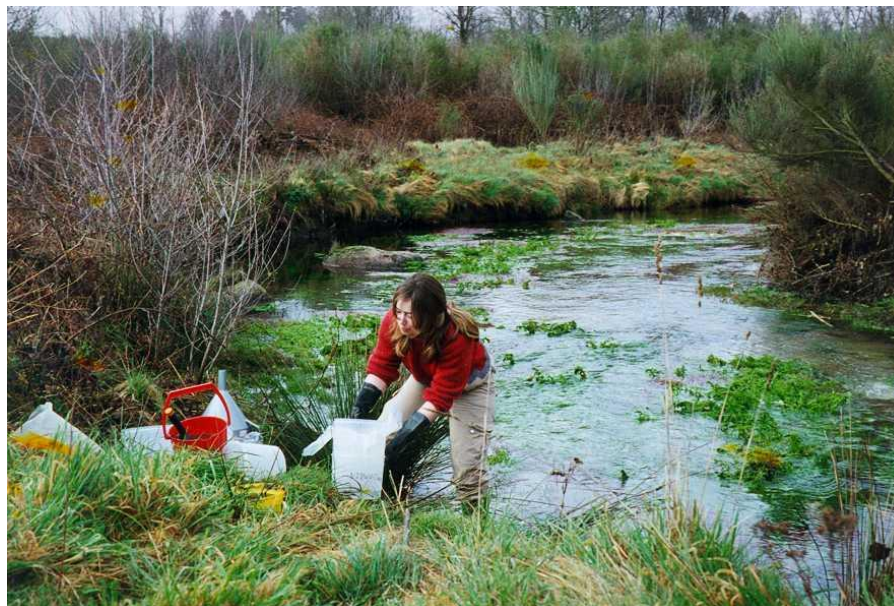
Figura 3.1.2. Proceso de tamizado en húmedo en campo ( < 150 \mu\text{m} ) en la toma de sedimentos de corriente (Portugal).
