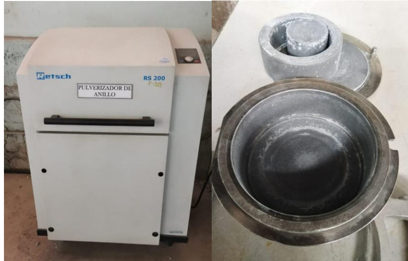
Figura 3.1.13. Pulverizadora de anillos concéntricos y anillos concéntricos de la pulverizadora
