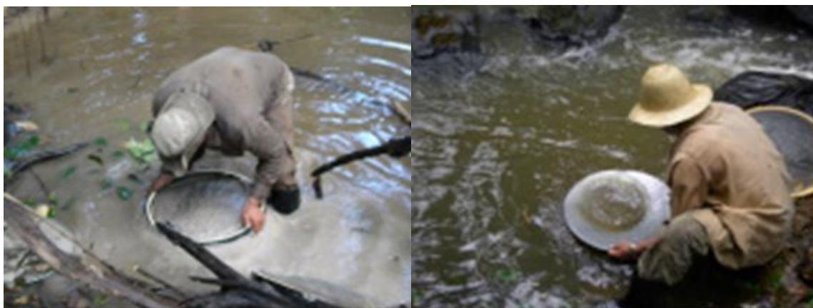
Figura 2.1.19. Concentración de minerales pesados en batea. Caracaraí, RR, Brasil, selva Amazónica
