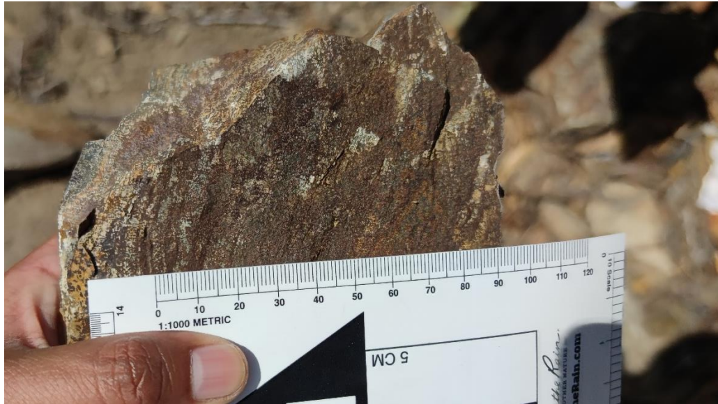
Fotografía 2. Muestra de mano de las cuarcitas de la Formación Ñaupe, donde se aprecian óxidos de hierro rellenando fracturas.
