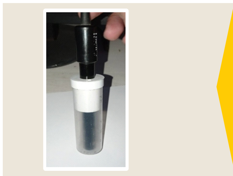
► Fig. 3 - Instalación de la sonda de conductividad
