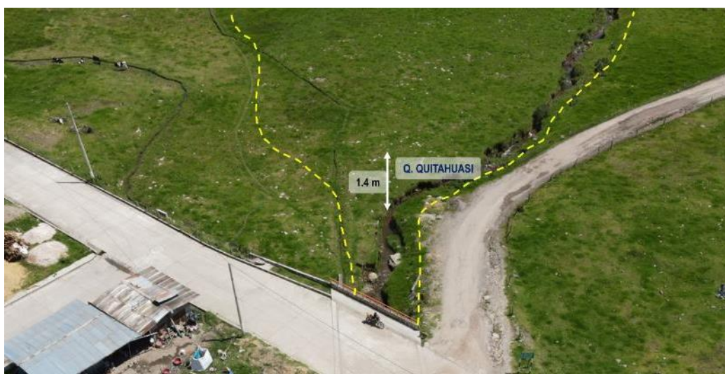
Figura 17. Terreno de pastoreo susceptible a desborde de la quebrada Quitahuasi, probable altura de inundación de 1.4 m. Ubicación: E: 740345, N: 9252998, Z: 2598.
