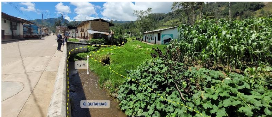
Figura 16. Terreno de cultivo susceptible a desborde de la quebrada Quitahuasi, probable altura de inundación de 1.2 m. Ubicación: E: 740273, N: 9252796, Z: 2604.
