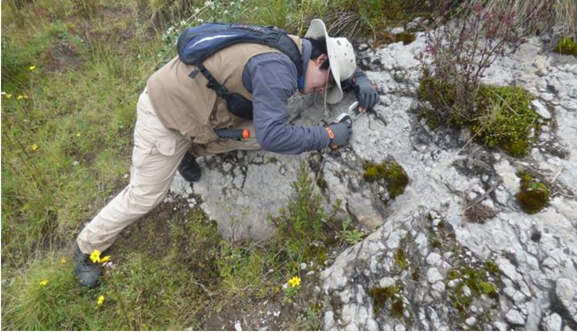
Fotografía 2 Afloramiento de calizas fosilíferas, rumbo de la estratificación a favor de la pendiente (Rumbo: N124°, : Buzamiento 32°SO, coordenadas: 278402E, 8952929N).
