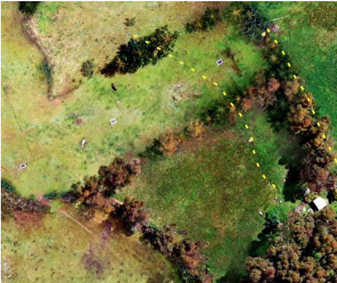
Figura 14. Imagen del dron (marzo 2023), se muestra los agrietamientos del terreno (Línea amarilla).
