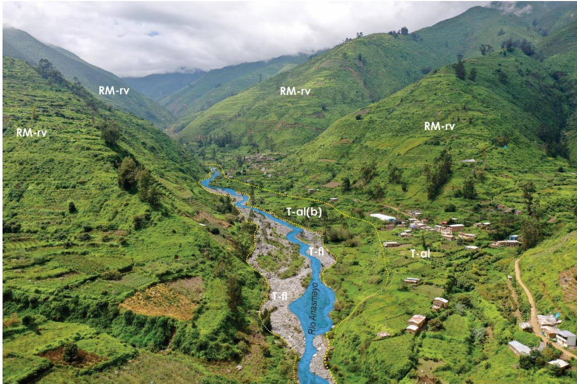
Figura 13. Vista de montaña en roca volcánica donde la pendiente del terreno entre fuerte a muy escarpadas, ubicadas en ambas márgenes del río Anasmayo.
