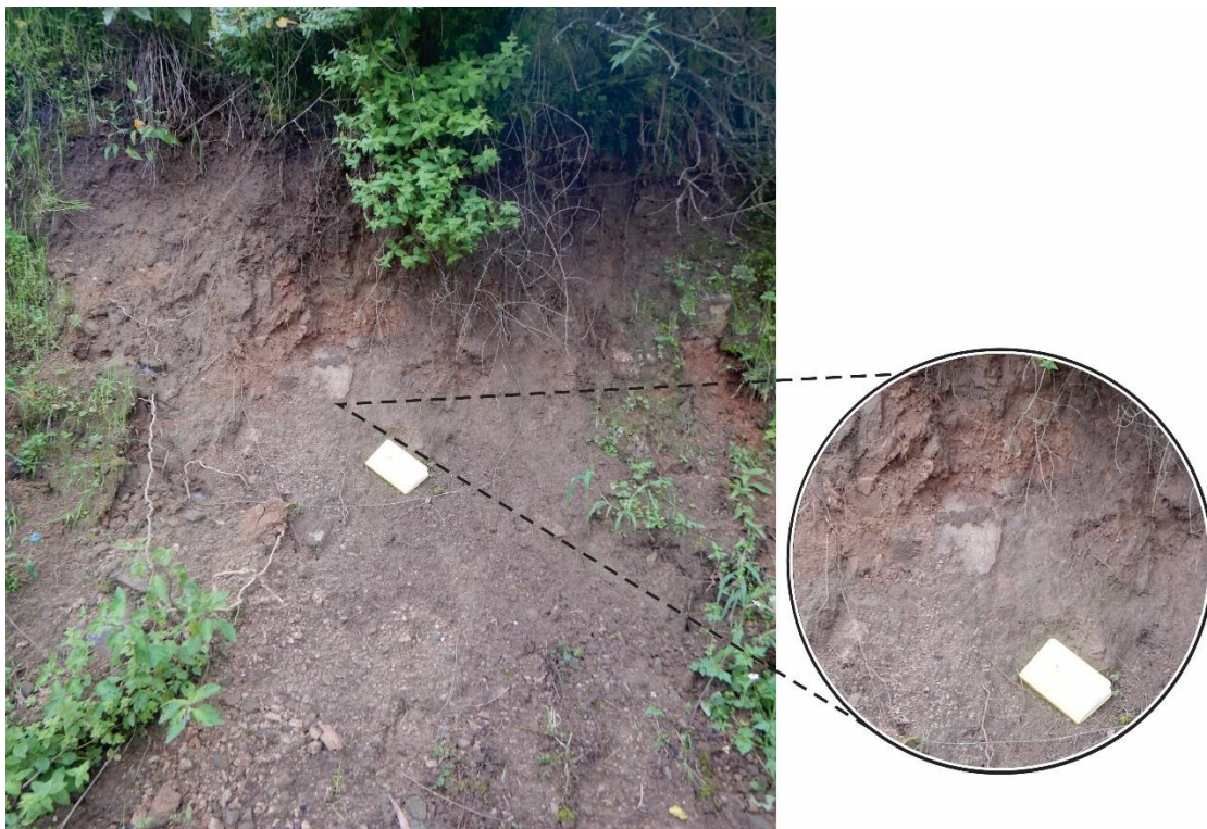
Figura 8. Depósito compuesto por fragmentos de rocas volcánicas subangulosos a subredondeados, heterométricos y envueltos en una matriz de arcillas, limos y arenas, ubicado la parte alta del centro poblado La Perla.
