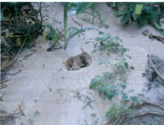
Fig. 11: Formación de volcanes de arena en el sector de Shango y Azungue (foto CISMID, 2005).
