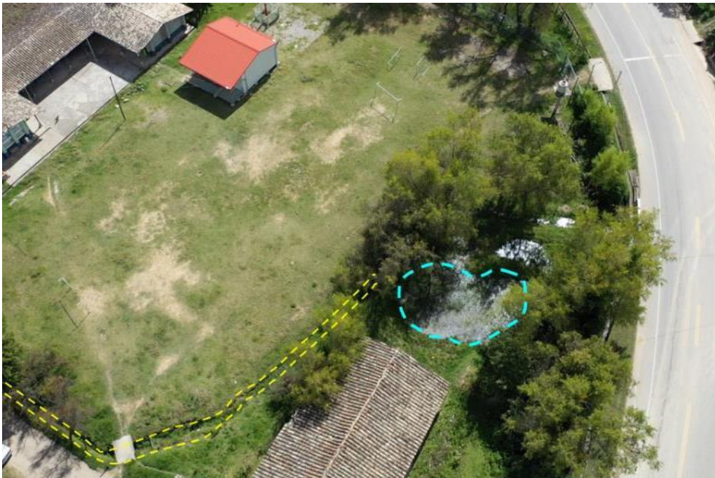
Figura 20. Se observa con líneas discontinuas amarillas, canaletas sin revestimiento y con líneas discontinuas celestes, acumulación de agua en el terreno, debido a la falta de un sistema de drenaje adecuado. Coordenadas: E: 819975, N: 9158647.
