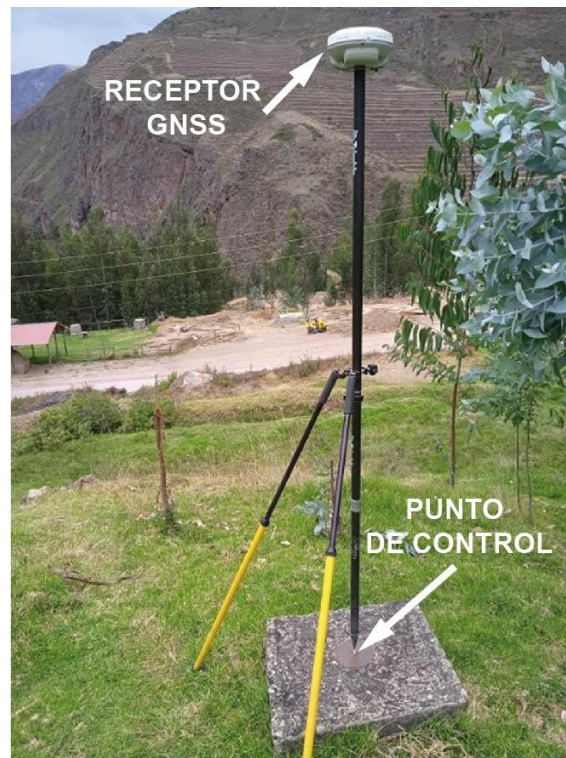
Figura 9. Hito de monitoreo o punto de control “CUYO” (actualmente denominado como CY06, ver figura 8) instalado en el 2009.
