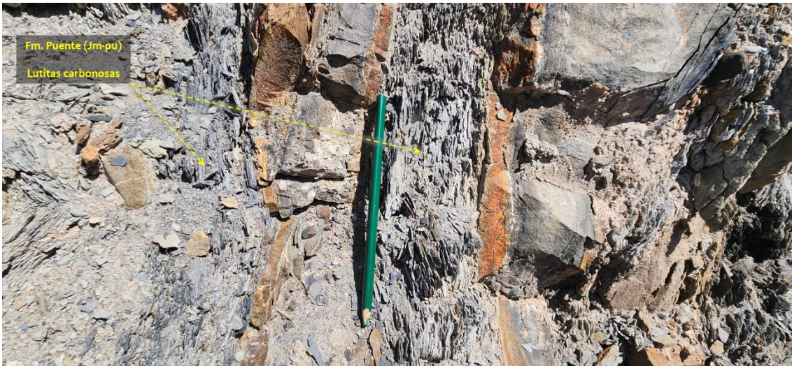
Figura 8. Sustrato rocoso de la Formación Puente – Sector Joto Jahuana. Muestra afloramientos de lutitas carbonosas moderadamente meteorizadas y fragmentadas (con espaciamentos menores a 5 cm). Estas se muestran astillosas y se separan lascas con facilidad.
