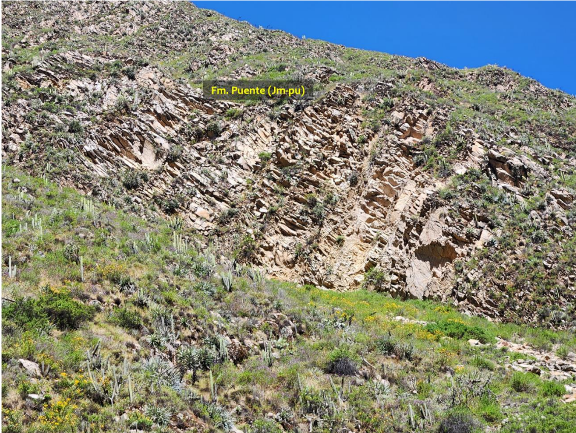
Figura 9. Sustrato rocoso de la Formación Puente – Anexo Subna. Se tienen areniscas grises, se encuentran moderadamente meteorizadas y medianamente fracturadas (espaciamiento entre 0.3 a 1 m).
