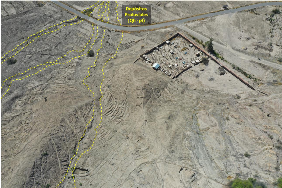
Figura 16. Se muestra los depósitos proluviales que se encuentran en el cerro Joto Jahuana, conformados por bloques con tamaños máximos de hasta 0.6 m, gravas y una matriz areno limo- arcillosa.
