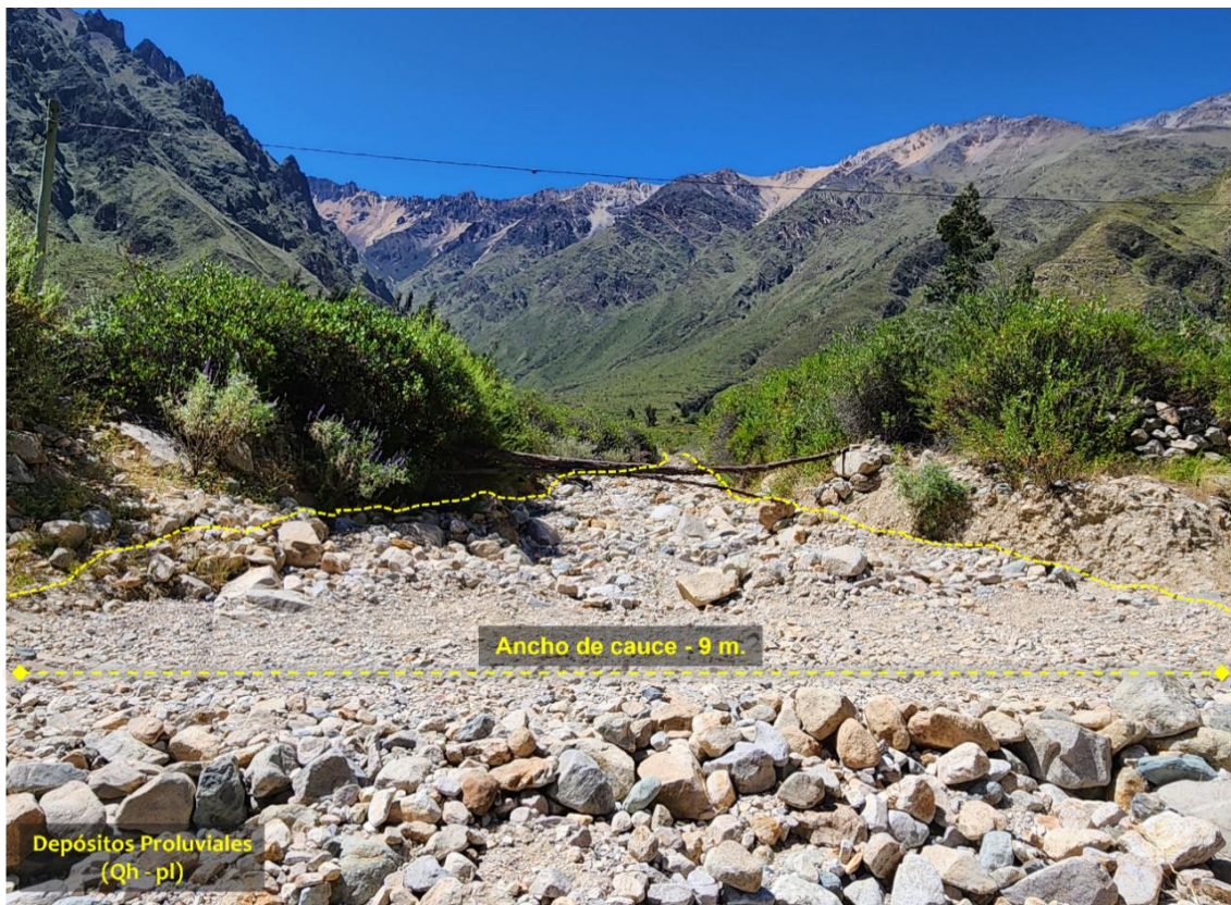
Figura 18. Se muestra los depósitos proluviales en el cauce temporal de agua localmente denominada quebrada Grande, conformado por bloques de tamaños máximos de 0.4 m., grava y escasa matriz areno limosa.
