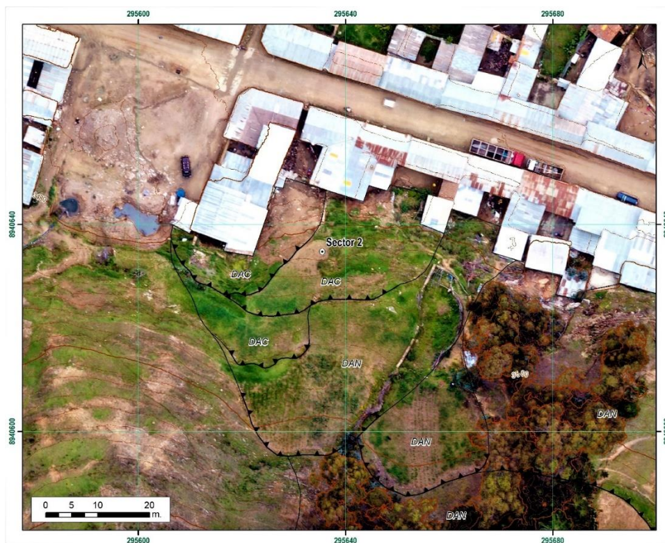
Figura 9. Delimitación de los deslizamientos activos (DAC) y antiguos (DAN) del Sector 2 sobre ortomosaico generado a partir de fotografías tomadas con dron.
