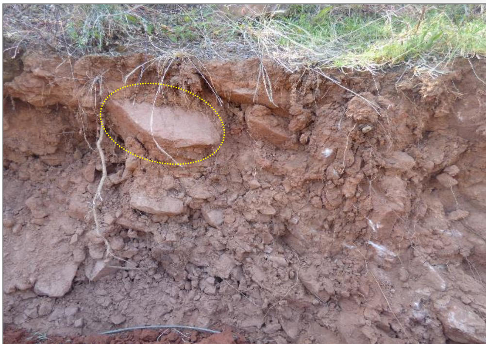
Figura 7. Depósito coluvial, compuesto por bloques angulosos, gravas arenas y limos, de compacidad medianamente suelta. En este corte, se tiene tamaño máximo de bloque 30 cm
