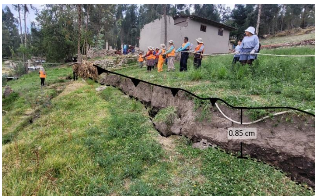
Figura 10. Vista de formación del escarpe principal (29 de agosto), con un salto vertical de 0.85m. Coordenadas: E: 781776, N: 9212131.
