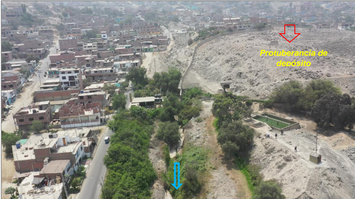
Figura 13. Protuberancia de depósito consolidado, dispuesto a la margen izquierda de la quebrada Santa María, sirve como barrera ante una posible afectación por flujo de detritos al terreno de Yanacoto II.
