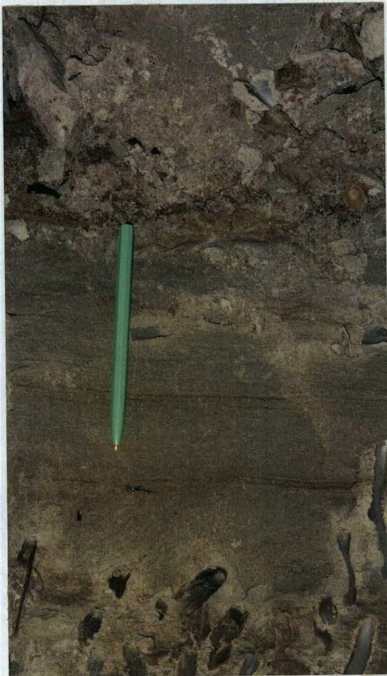
FOTO N° 14. Arenisca de color marrón claro con estratificación cruzada laminar. Fm. Ipururo. Localidad Kaupan. (Barranquita)
