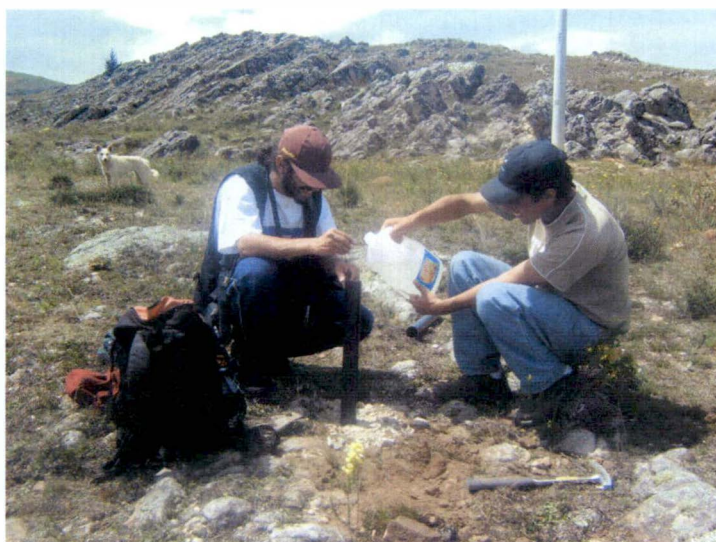
Prueba de infiltración en la formación Farrat
