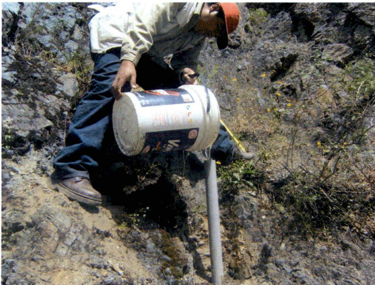
Prueba de infiltración en la formación Chimú
