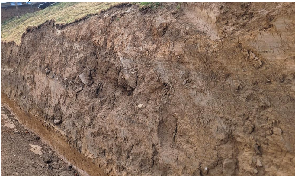
Fotografía 3. Se observa el depósito coluvio-deluvial, constituido por escasos bloques y gravas en una matriz areno limo arcillosa.
