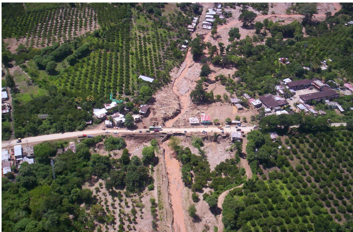
Fotografía 11. Vista aérea del flujo de detritos del año 2007, el flujo descendió de la quebrada Huacará, la luz del puente Huacará fue obstruido por la empalizada produciendo un desborde que llegó hasta la parte baja de San Ramón (Malecón Tarma, Urbanización Amauta, Bajada Acapulco, Urb. San Félix). Tomada de Nuñez & Medina, 2007.
