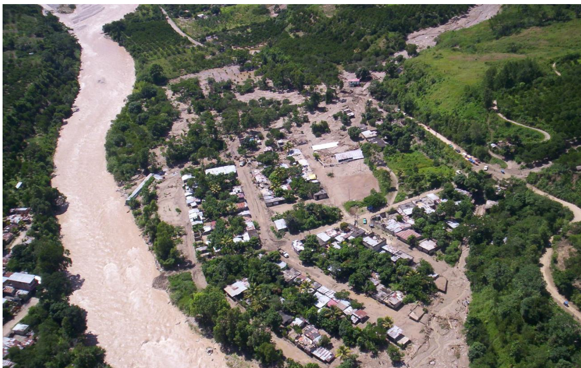
Fotografía 10. Vista aérea del flujo de detritos del año 2007, el flujo descendió de la quebrada Agua Blanca y Tulumayo afectó todo el sector de Juan Pablo II y alrededores. Tomada de Nuñez & Medina, 2007.
