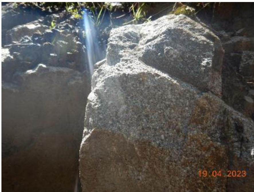
Fotografía 4: Dique intrusivo de composición granítica el cual se presenta muy fracturado y altamente meteorizado.
