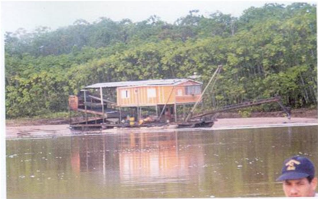
**Foto N° 8.3** Embarcación tipo draga, donde se observa la mesa vibratoria y una chupadora accionada mediante una bomba de absorción.
