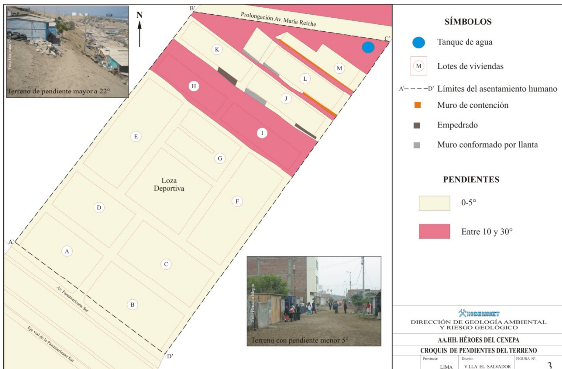
Figura 3.- Croquis esquemático de las pendientes del terreno.
