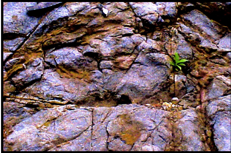
Foto N° 69: Roca volcánica silicificada cortada por múltiples vetillas con relleno limoníticos
