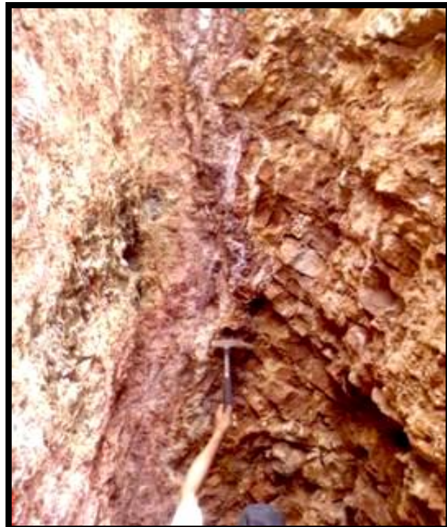
Foto N° 55: Veta de cuarzo con hematita. Roca caja alterada.
