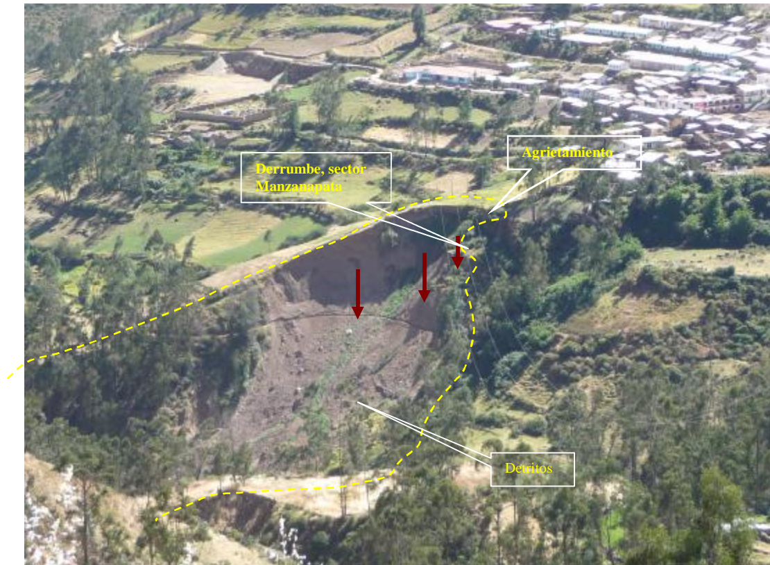
Foto N° 12 Vista panorámica del sector de Manzanapata se muestra el deslizamiento y la zona reactivada como derrumbe.
