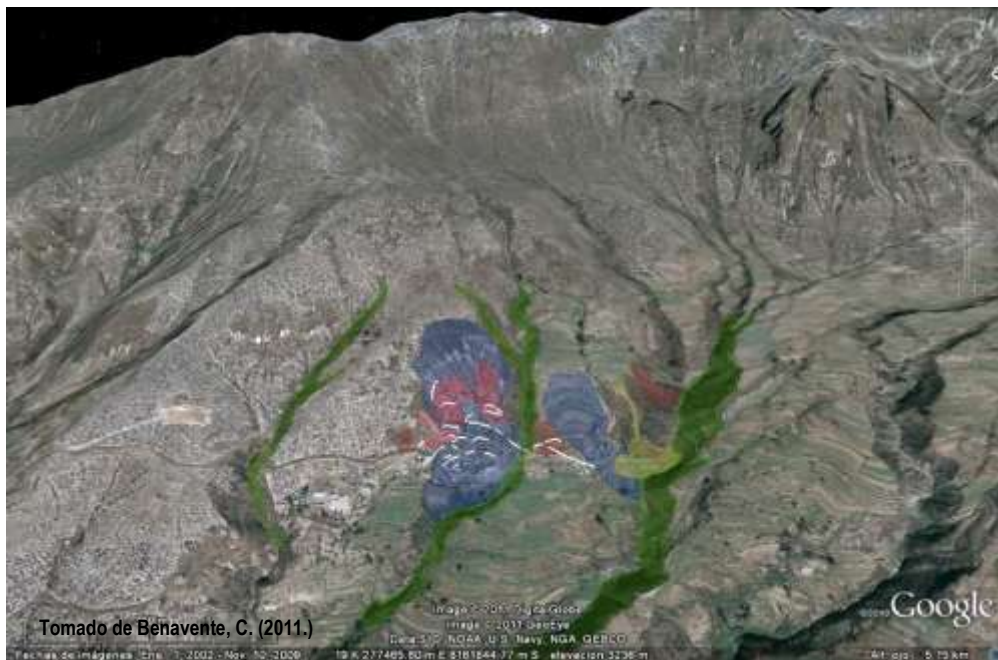
Figura 19.- Sector de Amata, de color azulado los deslizamiento antiguos, de color rojo las áreas reactivadas; de color verde las áreas de erosión de laderas.
