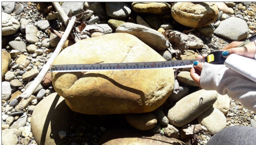
Fotografía 5. Vista de bloques de roca ígnea, transportados por el flujo, de 35 cm de diámetro.
