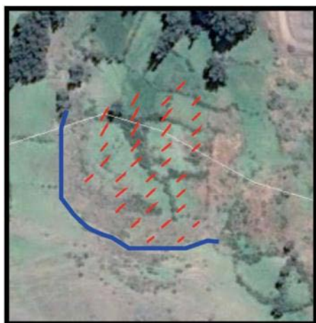
Figura 4: Izquierda. Desplazamientos del flujo de tierra entre los años 2011 y 2014.
