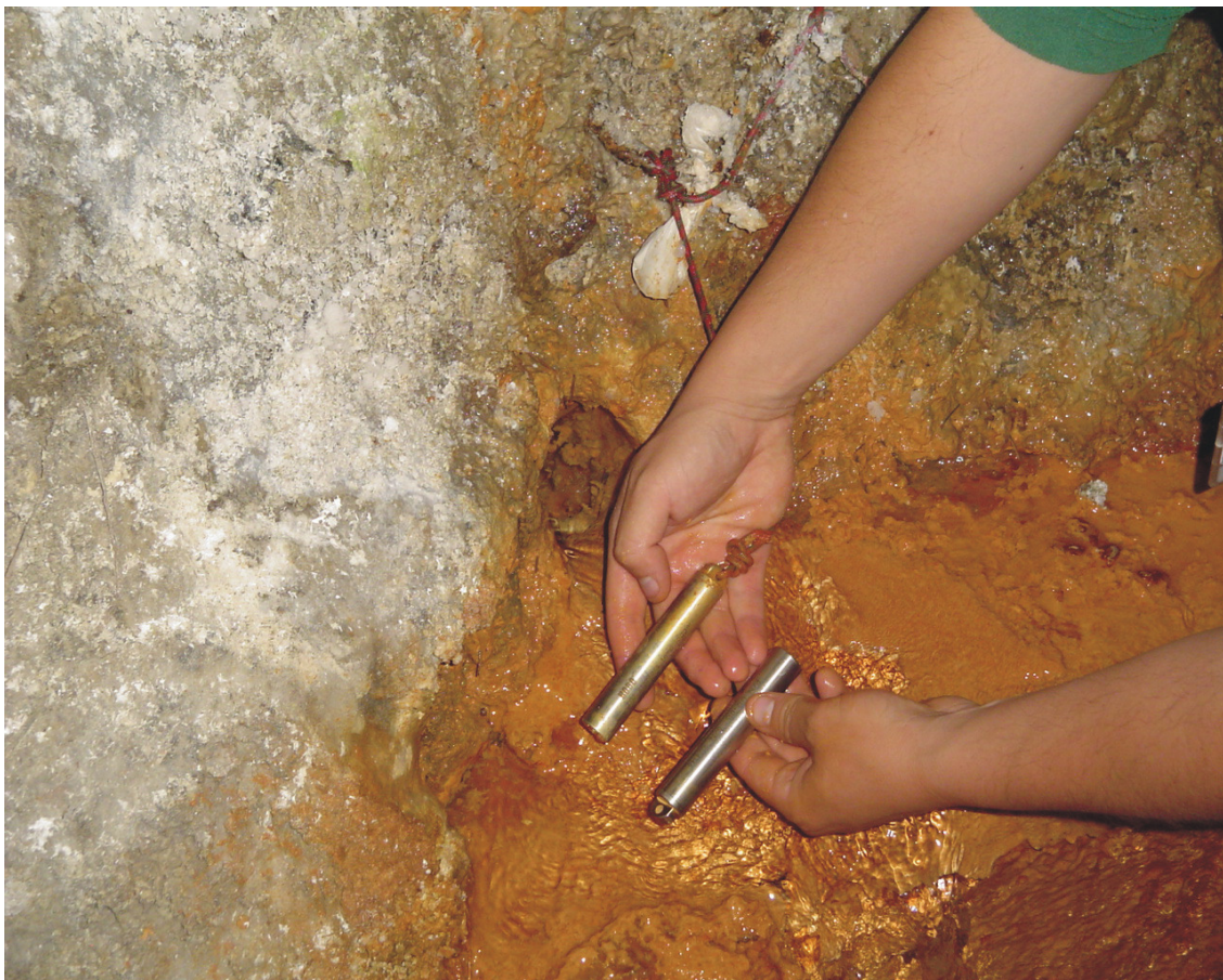
Fig. 7 – Sensores térmicos HOBO U12 – 015 en la fuente Charcani V.
