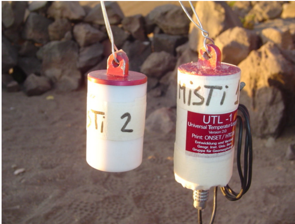
Fig. 10 – Sensores térmicos (data logger) UTL-1 (Universal Temperature Logger 1).
