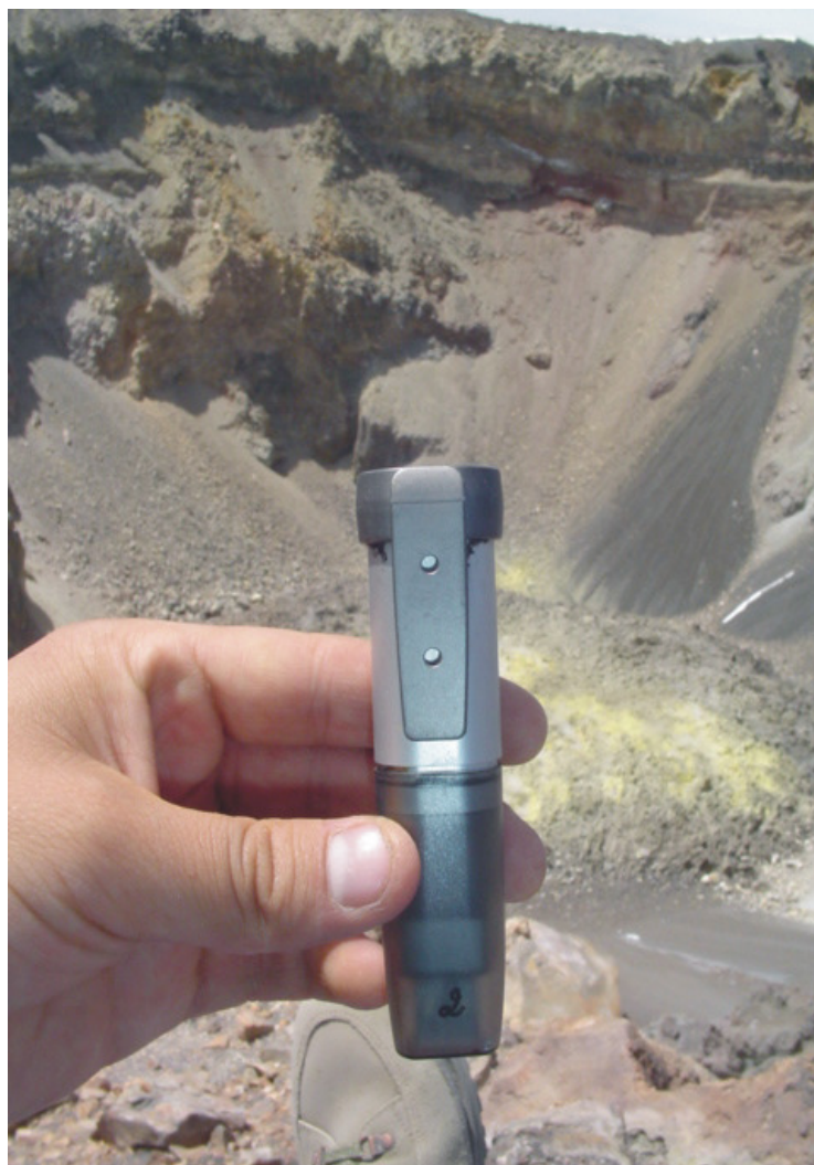
Fig. 8 – Sensores térmicos Registrador de Datos de Temperatura con Interfaz USB EL-USB- 1 en el punto de monitoreo borde del cráter 1.
