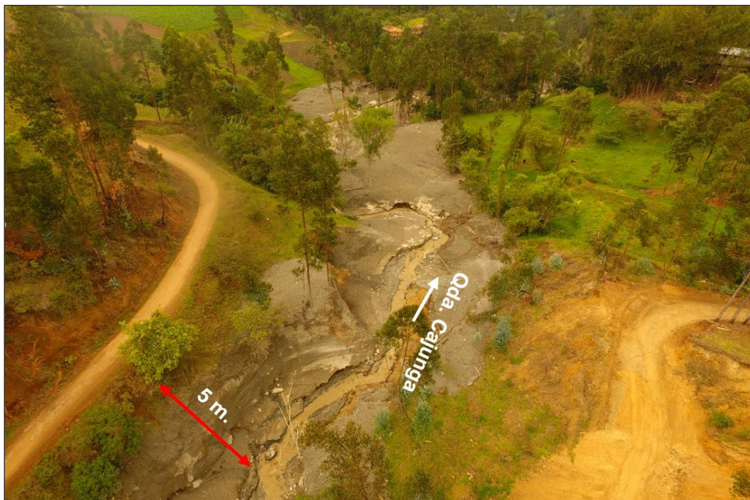
Figura 14: Vista del curso medio de la quebrada Cajunga. Obsérvese que en este sector la quebrada ha alcanzado alturas de hasta 5 metros y es visible la zona inundada.
