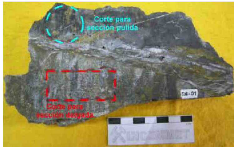
Foto. 2. Muestra de mano que donde el corte de sección delgada se hace en zonas que resaltan las características de la roca y el corte de sección pulida se hace donde se pueda apreciar las características de la mineralización
