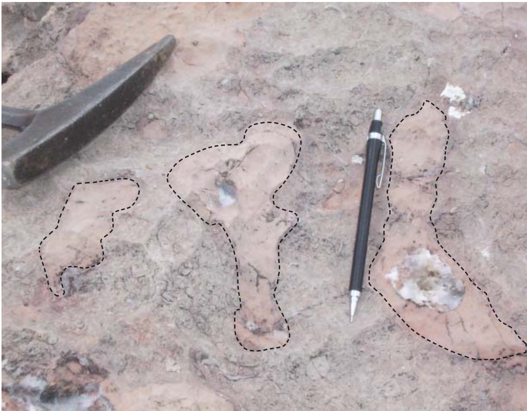
Detalle de las calizas bioclásticas con zonas de recristalización (resaltadas en líneas punteadas) de composición silíceas (cuarzo).
