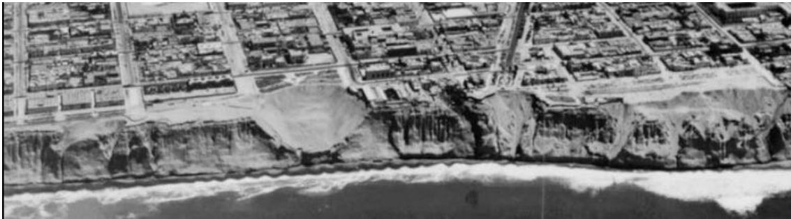
Figura 280. Foto aérea del distrito de Magdalena, se distinguen zonas de grandes cárcavas al borde del acantilado.
