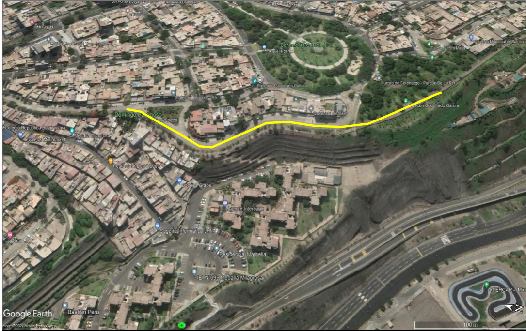
Figura 37. Foto del Acantilado de la Costa Verde y ubicación de la Línea Sísmica de Refracción RS02-MG a la altura de la parte posterior del complejo residencial Marbella en el distrito de Magdalena (Tomado de IGP, 2021).
