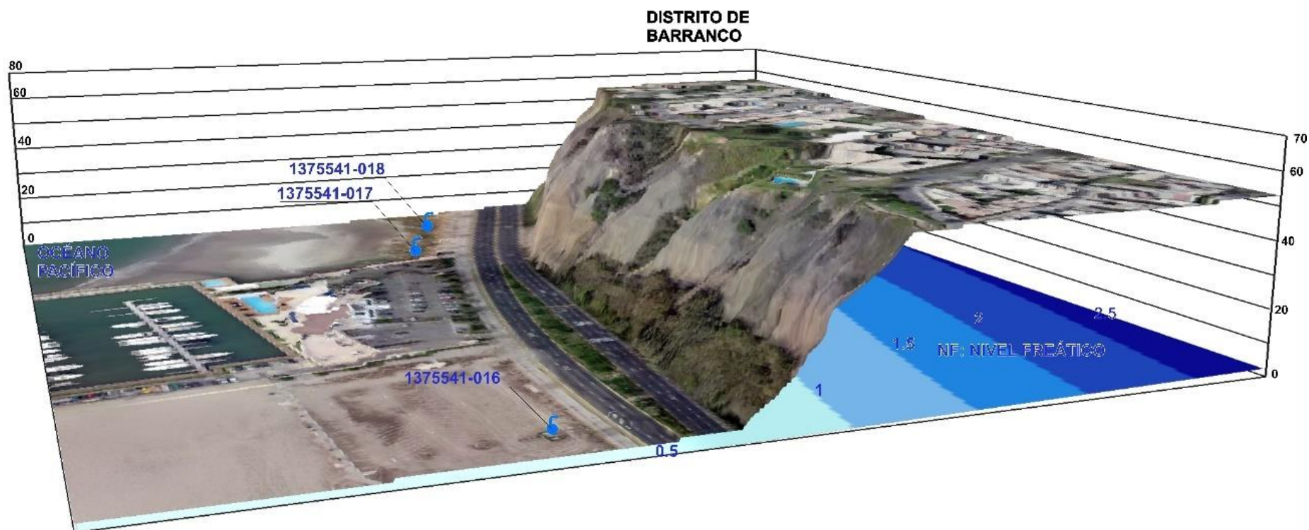
Figura 221. Distrito de Barranco se observa en colores azulados el nivel freático que va de 0 m a 2.5 m s.n.m.
