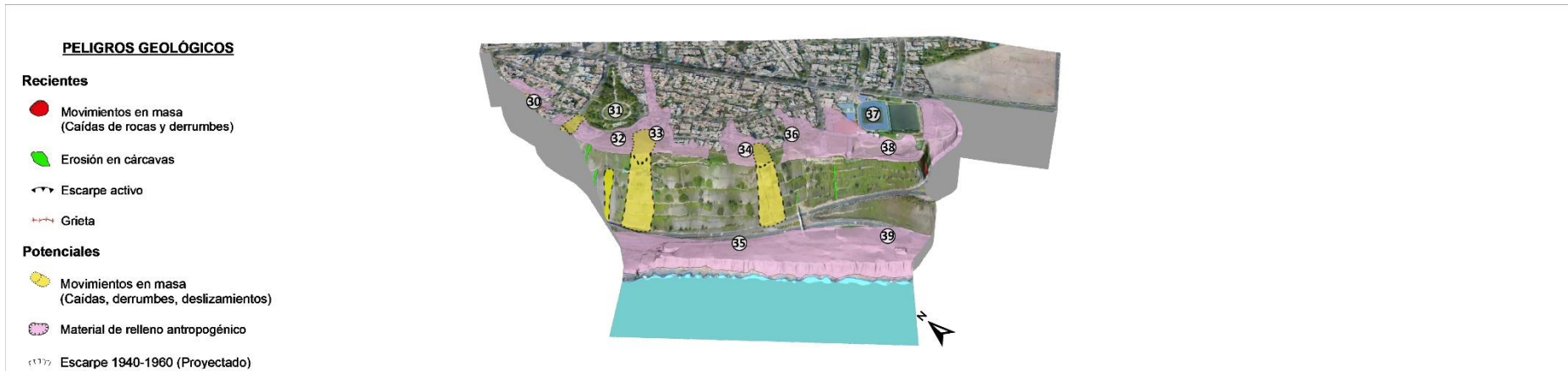
Figura 316. Peligros geológicos recientes y potenciales identificados entre los años 1943 y 1960 por zonas de rellenos antropicos. En la cartografía actual se observan grietas, escarpes y leves subsidencias que indican zonas de potenciales deslizamientos.
