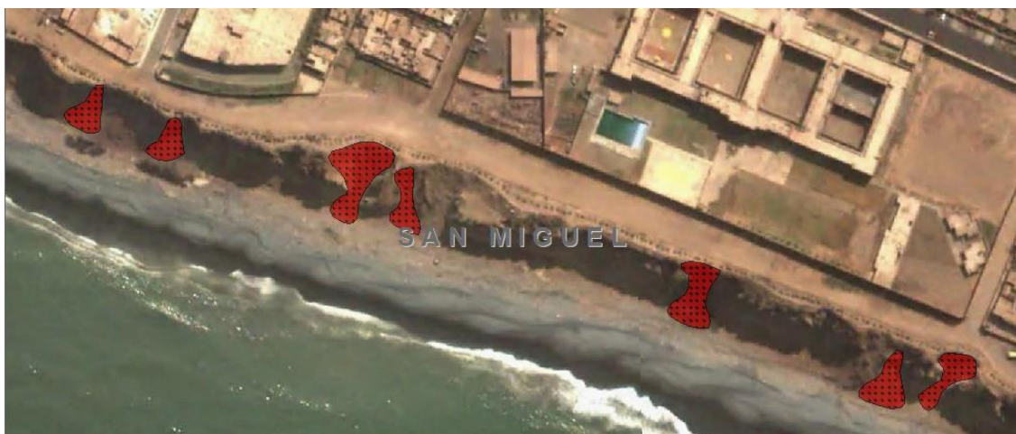
Figura 257. Imagen satelital del mes de junio del 2002 a la altura del Centro de Rehabilitación Maranga, se observan caídas de tipo derrumbes.
