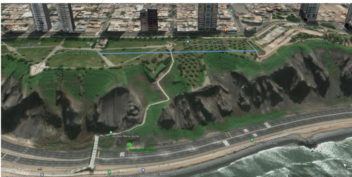
Figura 45. Vista del Acantilado de la Costa Verde y ubicación de la Línea Sísmica de Refracción RS15-MR a la altura del Parque María Reiche en el distrito de Miraflores (Tomado de IGP, 2021).
