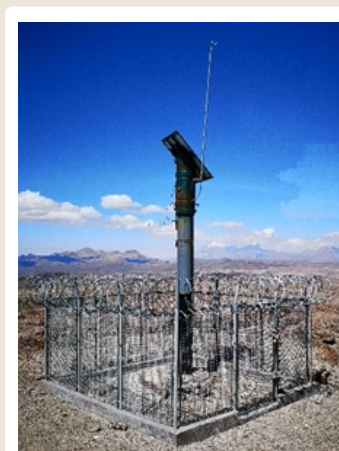
► Fig. 4 Estación multiparamétrica para monitoreo volcánico.
