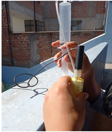
► Fig. 4- Comprobación del correcto funcionamiento del soporte para la sonda de pH
