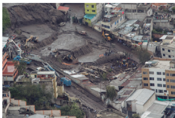
► Fig. 5 – Zona de afectación del eje norte. Detalle de la influencia del flujo de lodo sobre la escombrera (zona con escalones tipo terraza en el cuadro rojo) y la presencia del talud al este de la cancha de vóley. Tomado de El Comercio, (2022).
