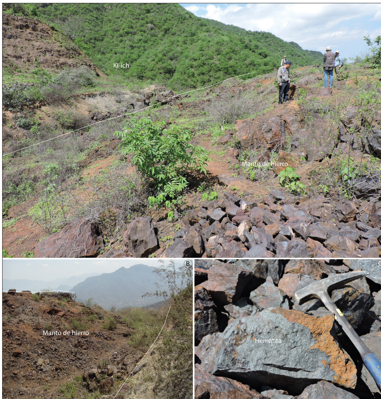
Figura 6.4 A y B) Manto ferrífero. C) Muestra de mano con alto contenido de hematita (UTM 691514, 9241656).
