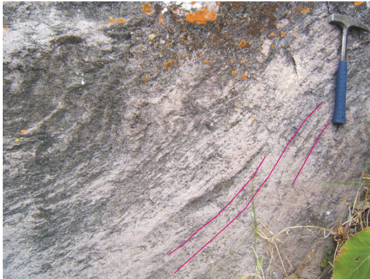
Figura 3.45 Ordenamiento de los minerales en una dirección (textura fluidal), una característica de los domos (izquierda).
