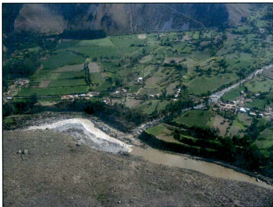
Foto 10: Vista aérea de la desembocadura de la Quebrada Runtumayo, mostrando la zona de represamiento en el río Vilcanota
