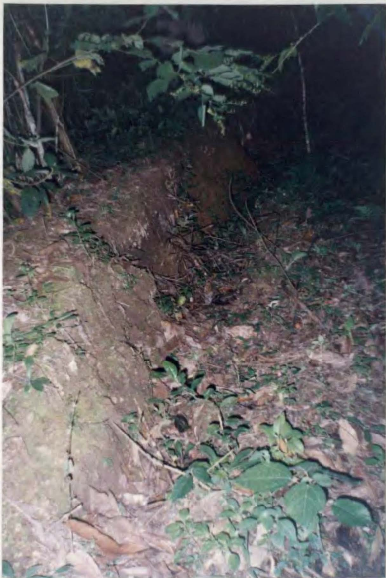
Foto N°5: Obsérvese: (A) Grietas con desplazamientos verticales entre 0.80-1 m., y otros menores (B) en los terrenos del Sr. Hugo Torres con aberturas de 0.15-0.20 m.
