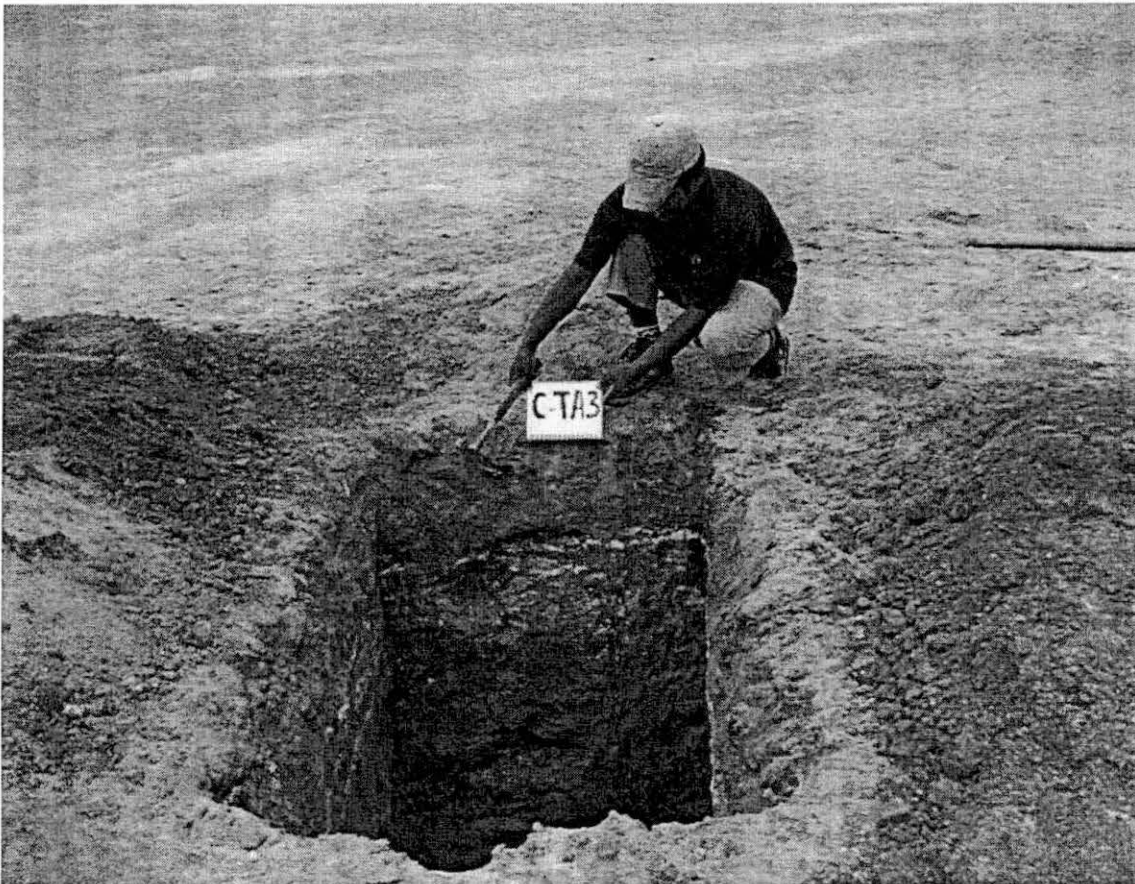
FOTO N° 16.- Vista de la Calicata 03, se aprecia el material fosfatado.
