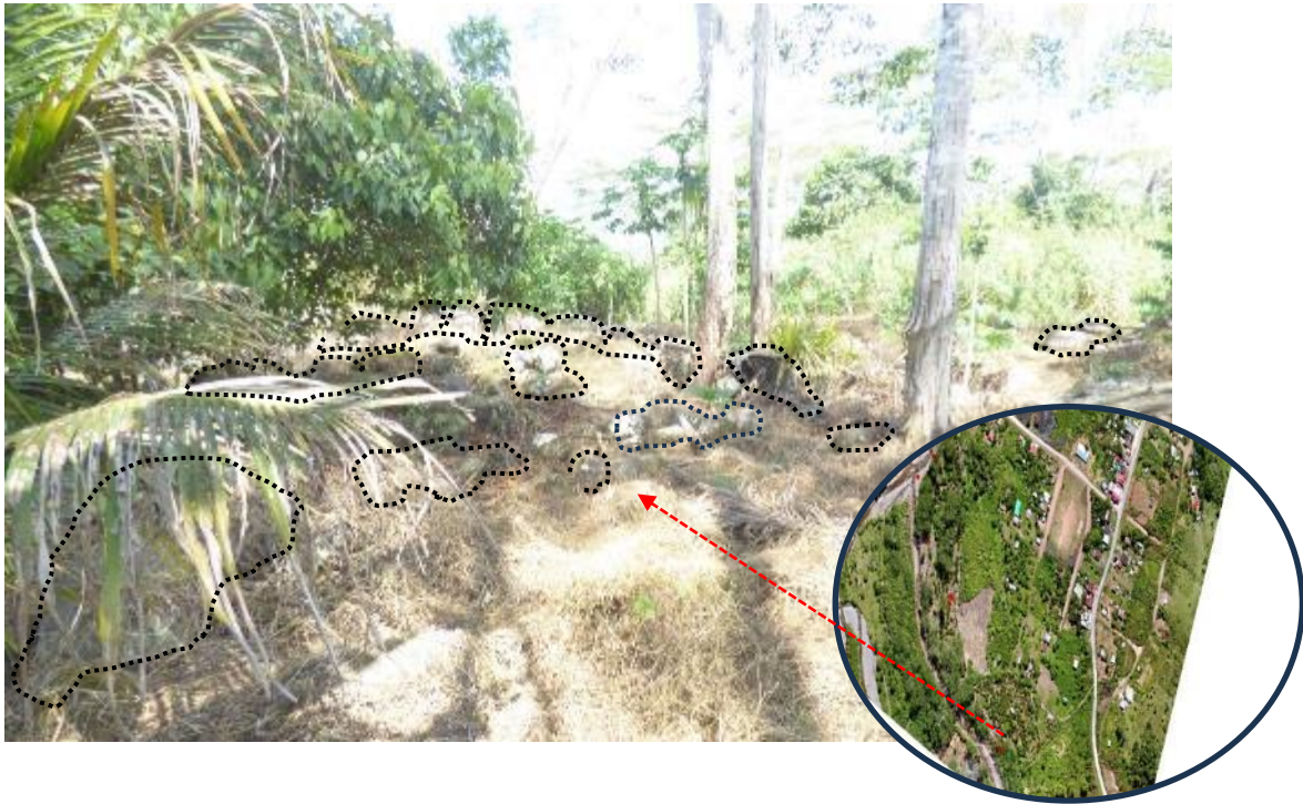
Figura 13: Trayecto de la quebrada Churuchumas de punto (E:486641, N:8821026), se observa deposito proluvial, presencia de bolones de hasta 1.5m de formas redondeados a subredondeados acarreados de la parte este de la quebrada.
