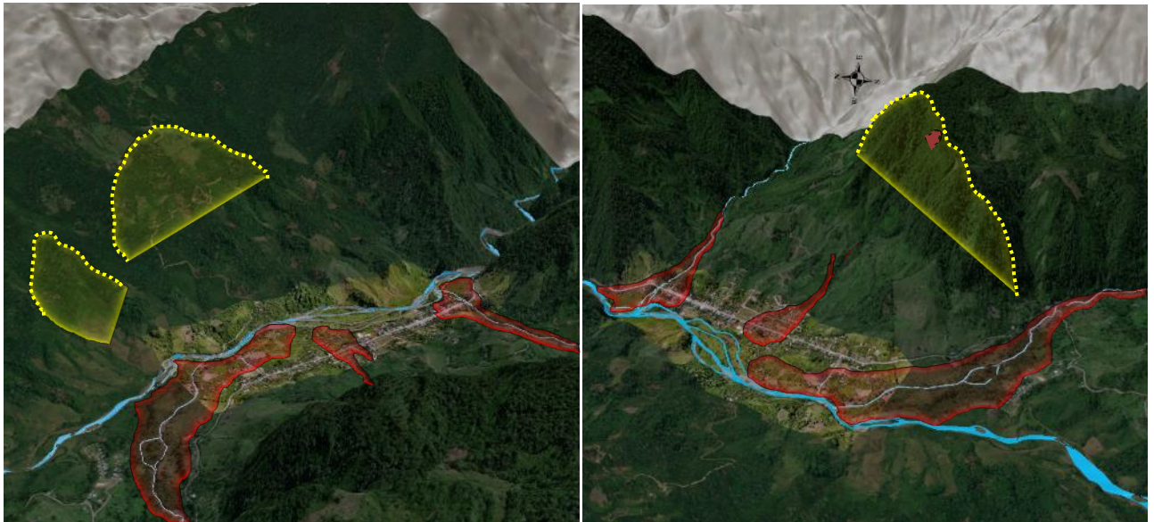
Figura 14: Imagen 3D. Representación de los peligros hallados en San Juan de Cacazú. Se observan en amarillo coronas de deslizamientos antiguos. En rojo flujos pasados y un deslizamiento reciente en anaranjado.
