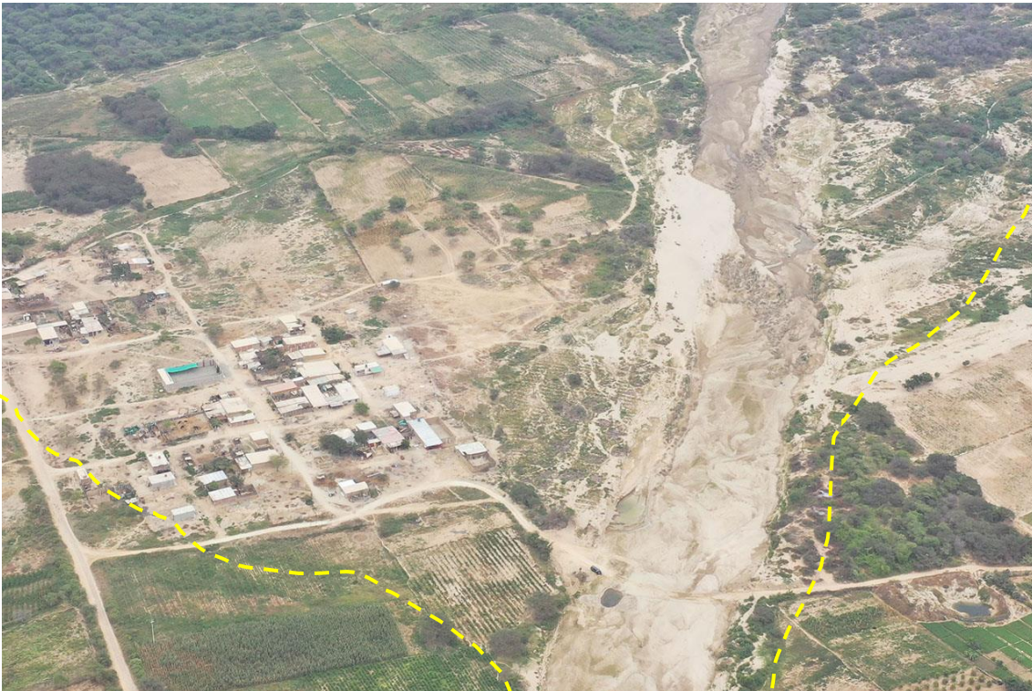
Fotografía 172. Zona crítica 14-141, inundación fluvial en la localidad de Monte Verde que podría afectar 500 m de vías locales y 50 viviendas. Coordenadas E: 616729; N:9287178. (08/09/23).
