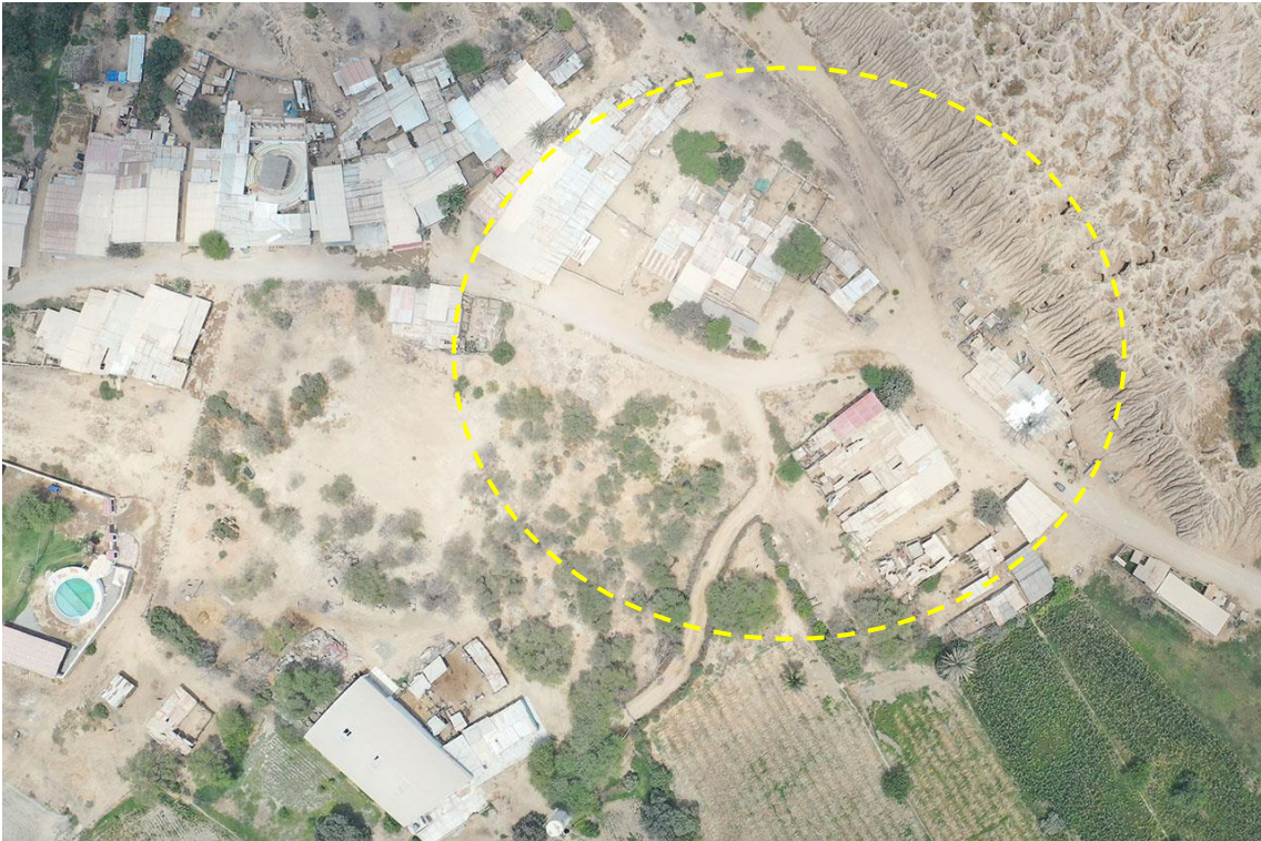
Fotografía 202. Zona crítica 14-171, flujo de detritos en la localidad de La Raya que podría afectar 25 viviendas y 50 m de la vía LA-606. Coordenadas E: 628419; N:9280103. (14/09/23).
