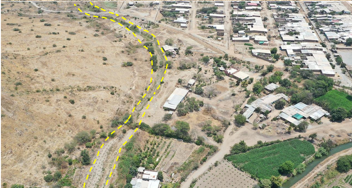
Fotografía 124. Zona crítica 14-093, flujo de detritos en la localidad de Pachерres que podría afectar 50 viviendas de la localidad ante colapso del canal de coronación. Coordenadas E: 663229; N:9250227. (26/09/23).
