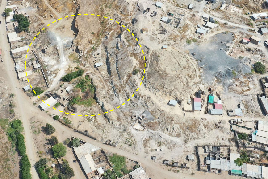
Fotografía 103. Zona crítica 14-072, Caída de rocas en la localidad de Cerro Corvacho que podría afectar 7 viviendas. Coordenadas E: 656923; N:9234898. (20/09/23).
