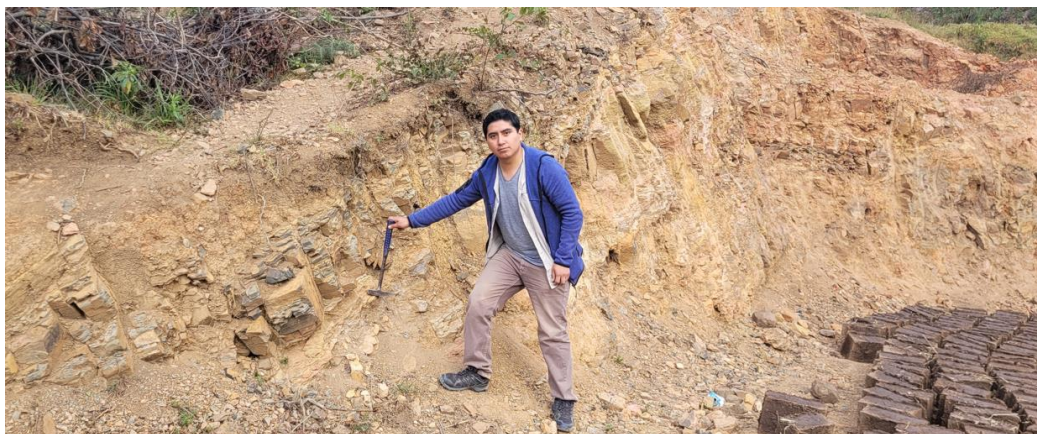
Fotografía 15. Macizo rocoso de tobas andesíticas intercaladas con lutitas muy fracturadas y altamente meteorizadas de la Formación Porculla. Coordenadas E: 691814; N: 9331484 (13/09/2023).
