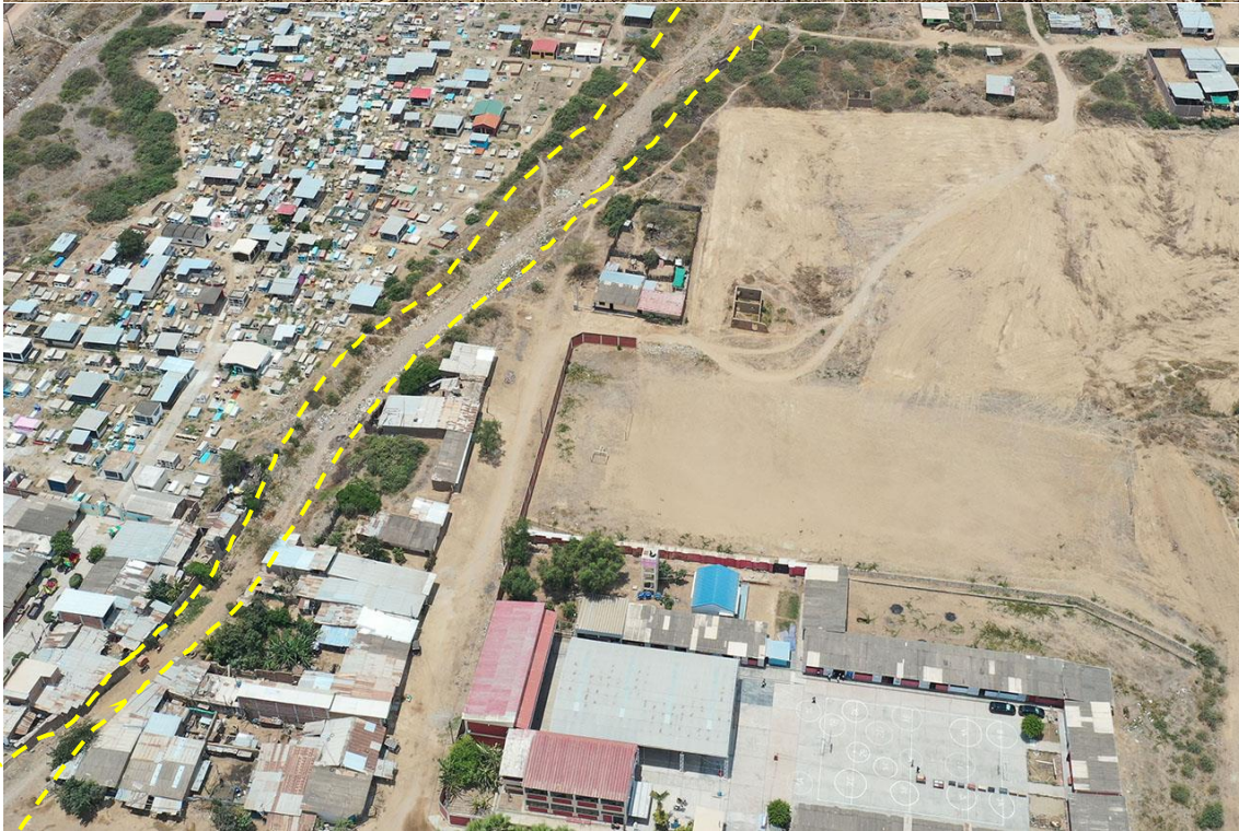
Fotografía 74. Zona crítica 14-043, flujo de detritos en la localidad de Quebrada El Cementerio 1 que podría afectar 3 viviendas y 50 m de una vía. Coordenadas E: 688062; N:9242526. (21/09/23).
