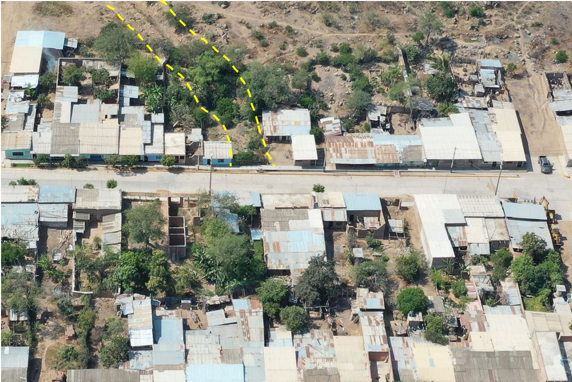
Fotografía 71. Zona crítica 14-040, flujo de detritos en la localidad de San Juan de Dios que podría afectar 7 viviendas. Coordenadas E: 683570; N:9239981. (22/09/23).
