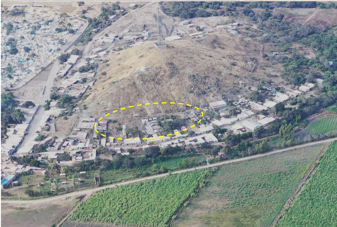
Fotografía 108. Zona crítica 14-077, flujo de detritos en la localidad de Cerro León que podría afectar 8 viviendas. Coordenadas E: 660259; N:9239098. (21/09/23).
