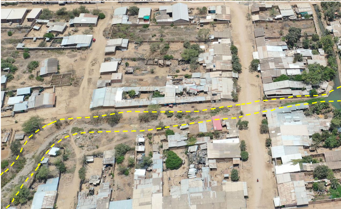
Fotografía 73. Zona crítica 14-042, flujo de detritos en la localidad de Quebrada Vista Alegre que podría afectar 10 viviendas. Coordenadas E: 687703; N:9241870. (21/09/23).
