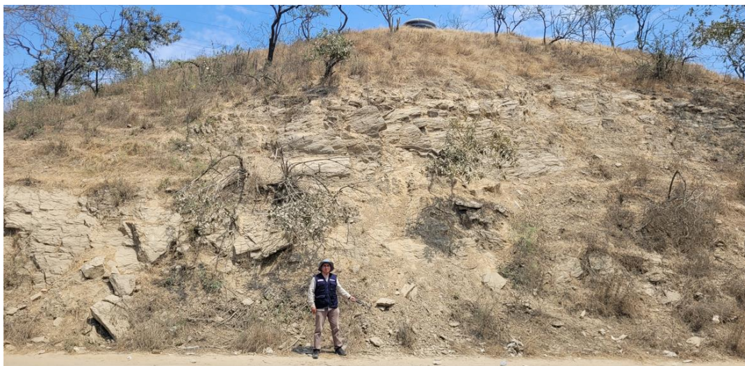
Fotografía 13. Macizo de esquistos muy fracturados y altamente meteorizados del Grupo Salas. Coordenadas E: 643871; N: 9327786 (11/09/2023).
