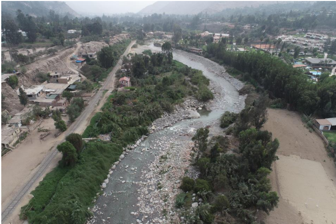
Fotografía 179. Zona crítica 15-056. Vista del cauce colmatado del río Rímac, puede afectar vía férrea y viviendas del sector California Baja en la margen izquierda del río. Coordenadas UTM 18S E311968; N8677951 (tomada el 06/10/2023).
