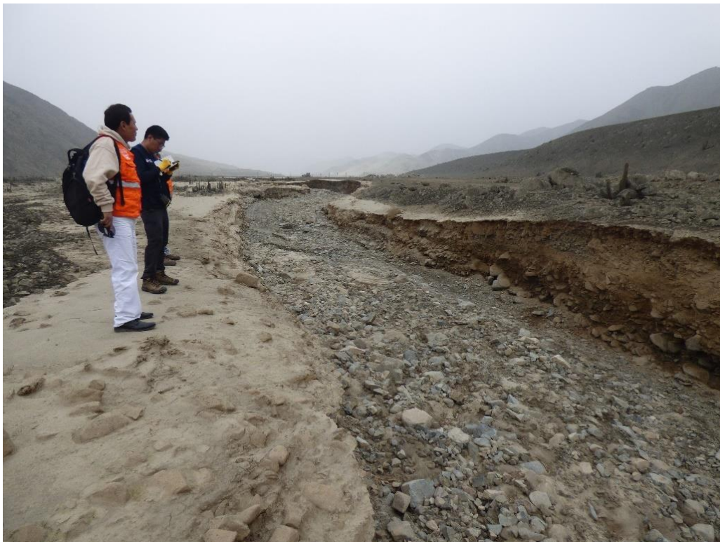
Fotografía 182. Zona crítica 15-059. Vista de la cuenca media de la quebrada Pucará en Lurín, se observa marcas del último flujo de detritos del 16/03/2023, aguas abajo afectó almacenes y viviendas del sector Macropolis. Coordenadas UTM 18S E306674; N8647496 (tomada el 05/09/2023).
