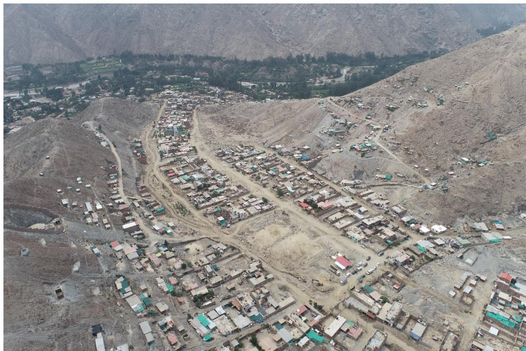
Fotografía 75. Zona crítica 15-018. Vista con dron de la quebrada Río Seco, aguas abajo, se observa viviendas de la Asociación de Vivienda Residencial Río Seco ubicadas dentro del cauce de la quebrada que ha sido rellenado, vía de acceso asfaltada se destruyó con el flujo de detritos del 14/03/2023. Coordenadas UTM 18S E309041; N8664542 (tomada el 21/03/2023).
