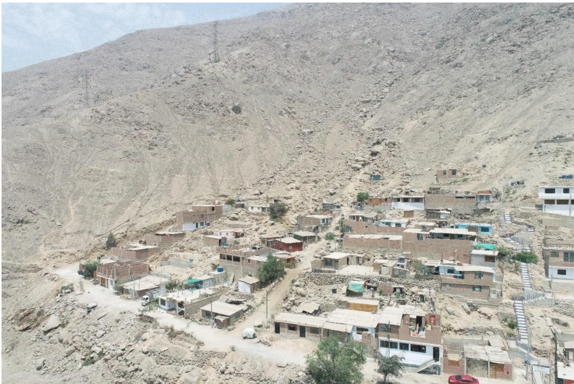
Fotografía 126. Zona crítica 15-038. Vista con dron puede observar las quebradas con material suelto que descienden del cerro Huampaní y puede generar huaicos. Coordenadas UTM 18S E309540; N8677216 (tomada el 24/11/2022).
