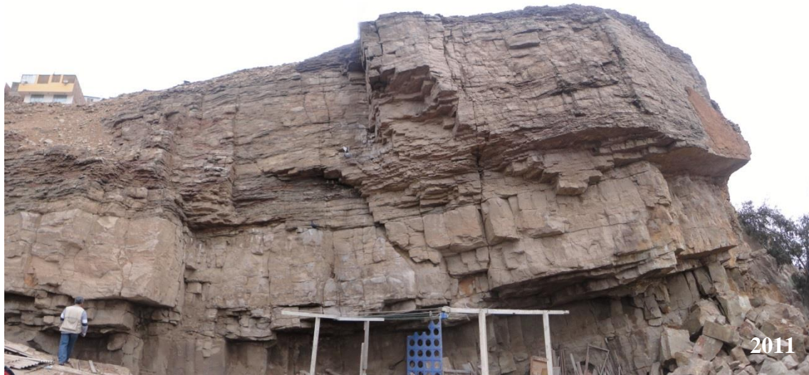
Figura 5. Secuencia de arenisca cuarzosa en bancos subhorizontales y medianamente fracturada y rellenadas con cristales de halita y roca triturada con niveles de limolitas craquelada, muy fracturada y alterada que sobreyacen a las areniscas de la Formación Marcavilca, en el sector Inty Llacta (Chorrillos).
