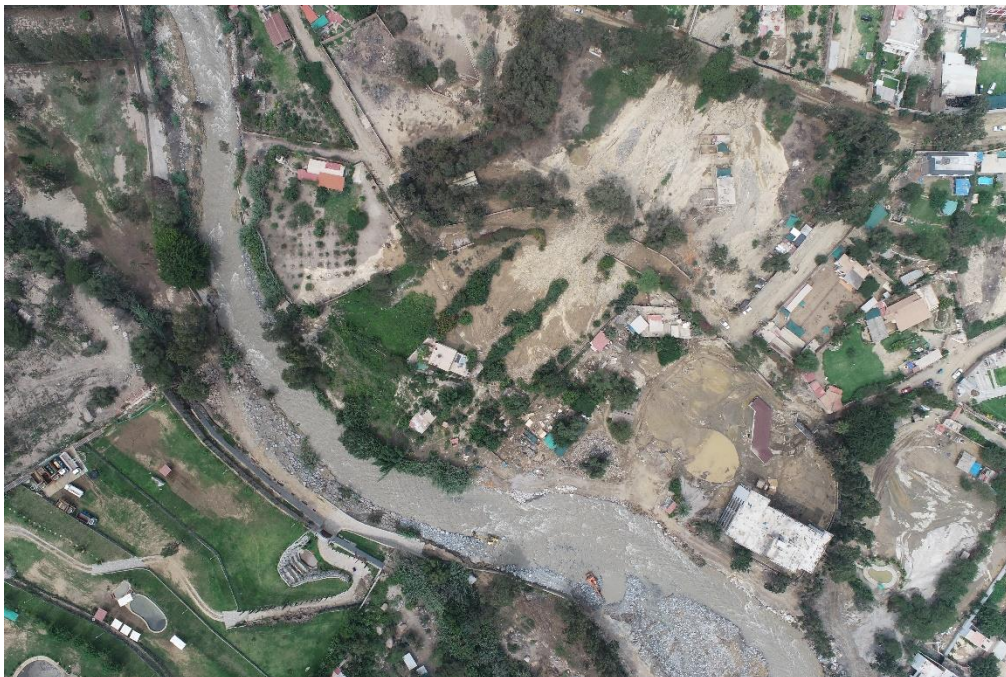
Fotografía 80. Zona crítica 15-019. Vista con dron de las viviendas, centros recreacionales y terrenos de cultivo afectados por el flujo de detritos del 14/03/2023 en la parte baja de la quebrada Río Seco. Coordenadas UTM 18S E310680; N8663875 (tomada el 21/03/2023).
