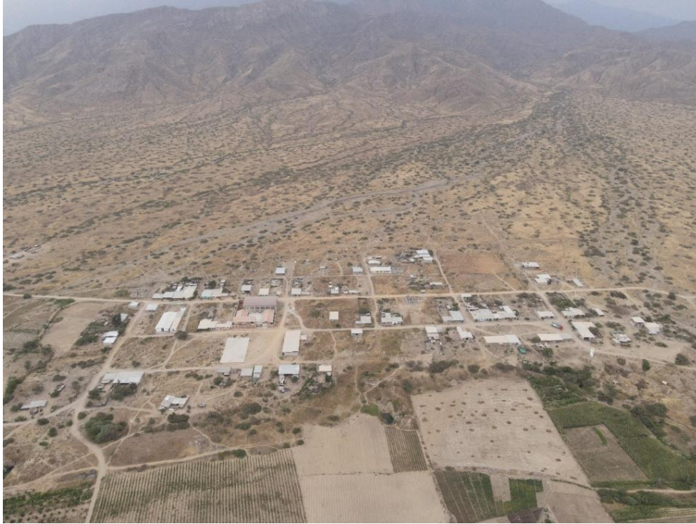
Fotografía 77. Zona crítica 13-042. Población del sector La Aventuranza asentados sobre depósitos de flujo de detritos y en múltiples torrenteras que se activa con las lluvias excepcionales (distrito de Nanchoc). Coordenadas UTM: 685281 / 9211246, Zona 17. Tomado el 26-09-2023.
