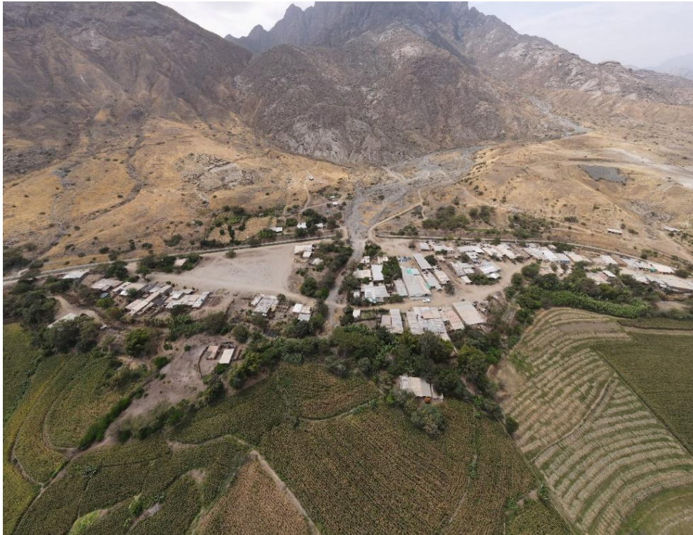
Fotografía 73. Zona crítica 13-040. Viviendas del sector Algarrobal de San Mateo asentadas sobre depósitos de flujos de detritos y en desembocadura de quebrada sin nombre (distrito de Chepén). Coordenadas UTM: 682232 / 9192145, Zona 17. Tomado el 25-09-2023.
