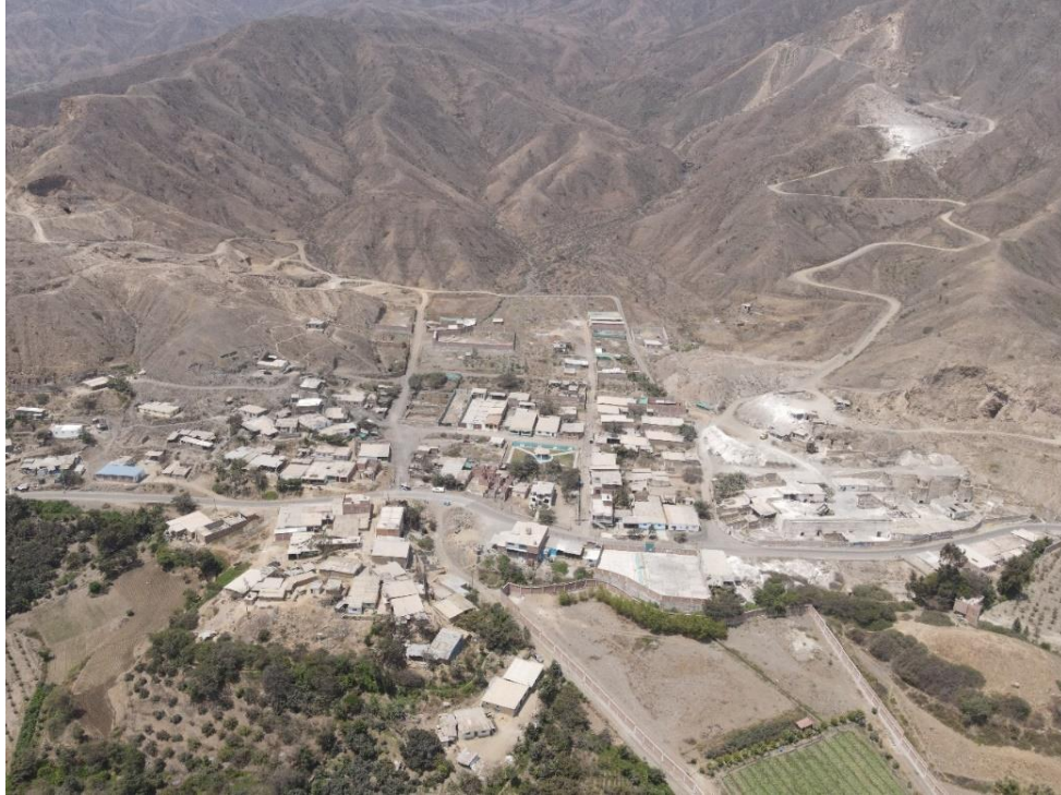
Fotografía 31. Zona crítica 13-015. Se observa viviendas del centro poblado Cajamarca asentadas sobre depósitos de flujos de detritos con múltiples torrenteras, que se activan con lluvias excepcionales como las que ocurre durante los fenómenos El Niño y otros (distrito de Simbal). Coordenadas UTM: 741476 / 9119057, Zona 17. Tomado el 15-09-2023.
