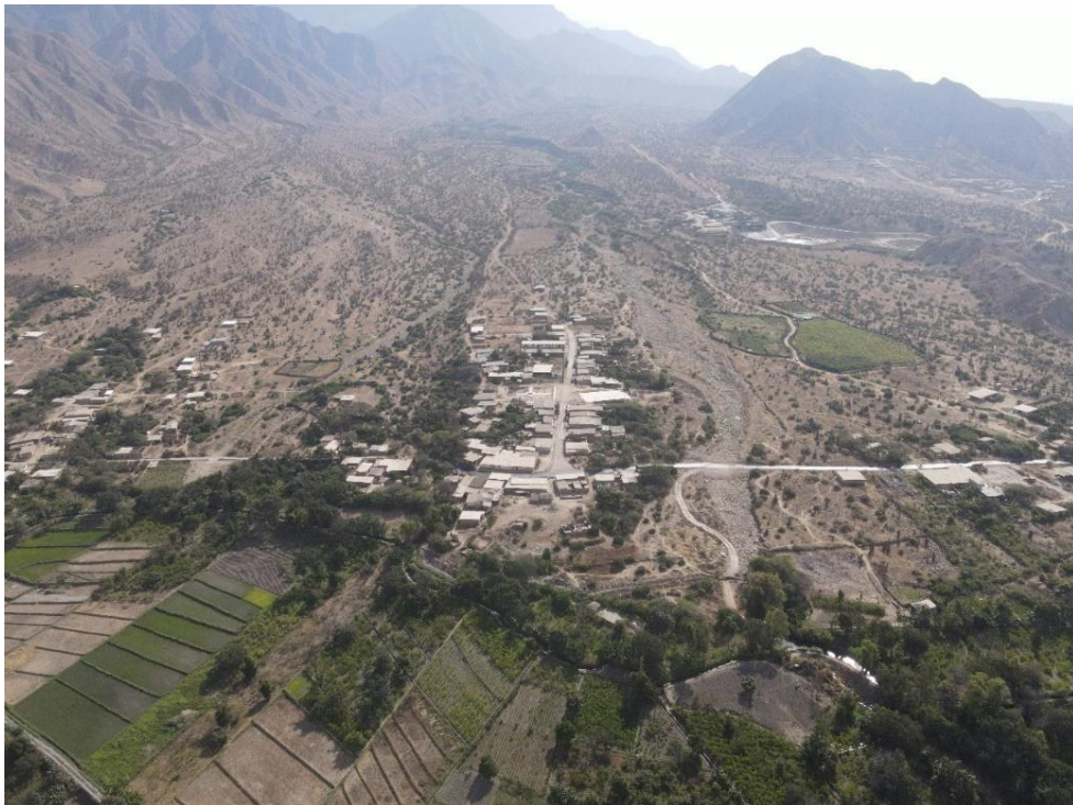
Fotografía 119. Zona crítica 13-067. Viviendas del sector Cerro Negro asentadas sobre depósitos de flujos de detritos y en la desembocadura de la quebrada Arrancamachete (distrito de Marmot).
