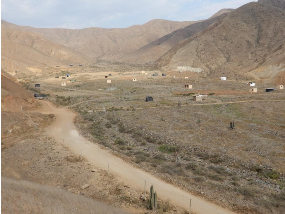
Fotografía 37. Zona crítica 13-018. Se observa construcciones de viviendas provisionales en los espacios en proceso de lotización del sector Cholocal 2 ubicadas sobre depósitos de flujos de detritos con múltiples torrenteras (distrito de Simbal). Coordenadas UTM: 741123 / 9115696, Zona 17. Tomado el 15-09-2023.
