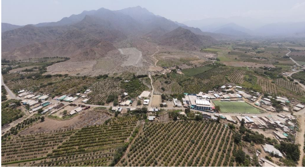
Fotografía 121. Zona crítica 13-068. Viviendas del sector El Niño asentadas sobre depósitos de flujos de detritos ubicadas y en la desembocadura de quebrada del mismo nombre (distrito de Virú).
