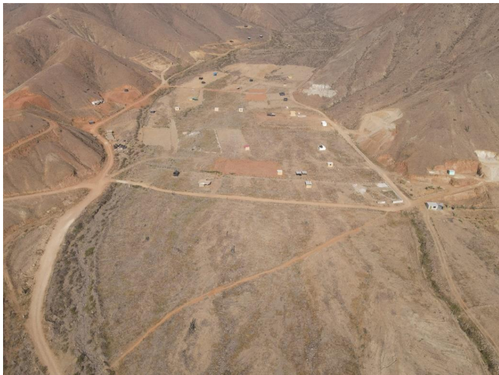
Fotografía 36. Zona crítica 13-018. Espacios en proceso de lotización del sector Cholocal 2 ubicadas sobre depósitos de flujos de detritos (huaicos) con múltiples torrenteras que se activan con lluvias excepcionales como las ocurridas durante los fenómenos El Niño y otros (distrito de Simbal). Coordenadas UTM: 741123 / 9115696, Zona 17. Tomado el 15-09-2023.
