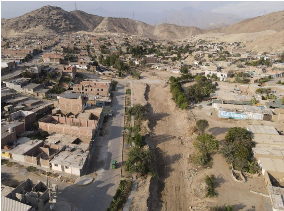
Fotografía 14. Zona crítica 13-006. Vista aguas arriba del cauce de la quebrada Las Palmeras en el distrito La Esperanza por donde se canalizó flujos de lodo durante el ciclón Yaku. Actualmente se observa trabajos de limpieza provisional. Coordenadas UTM: 715013 / 9109554, Zona 17. Tomado el 13-09-2023.
