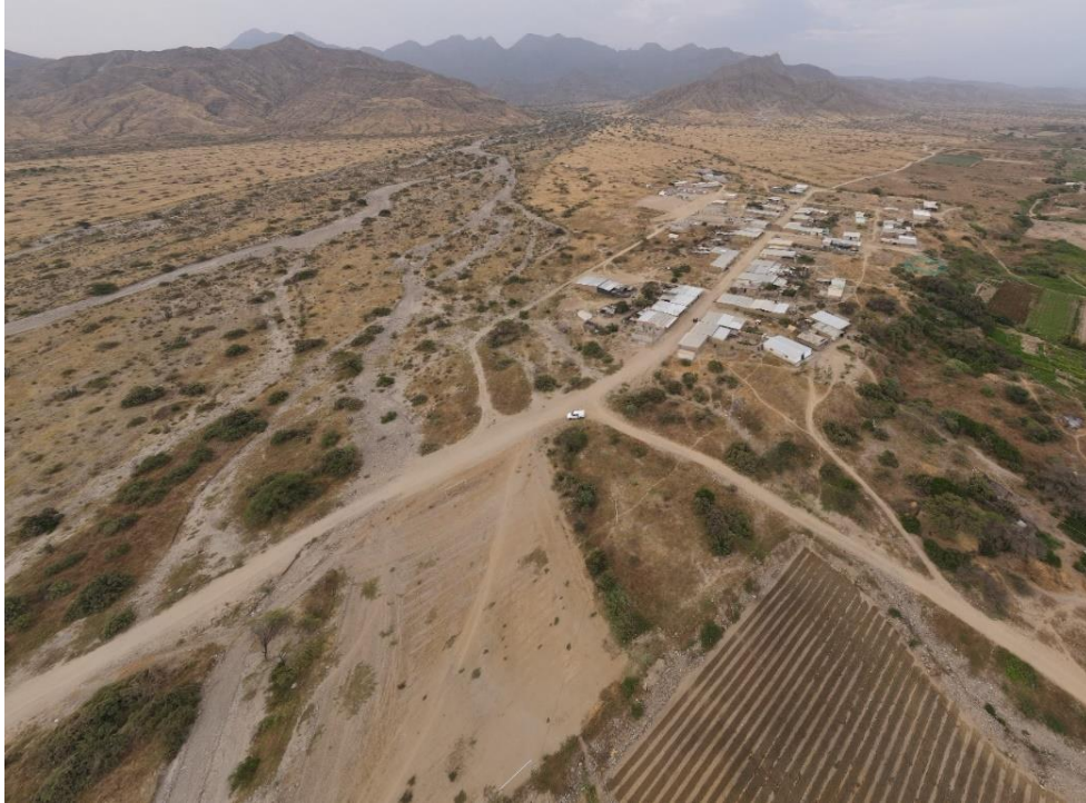
Fotografía 75. Zona crítica 13-041. Viviendas del centro poblado Huaca Blanca Alta asentadas sobre depósitos de flujo de detritos y en la margen izquierda del cauce de la quebrada Los Algarrobos (distrito de Pacanga). Coordenadas UTM: 682106 / 9210291, Zona 17. Tomado el 26-09-2023.
