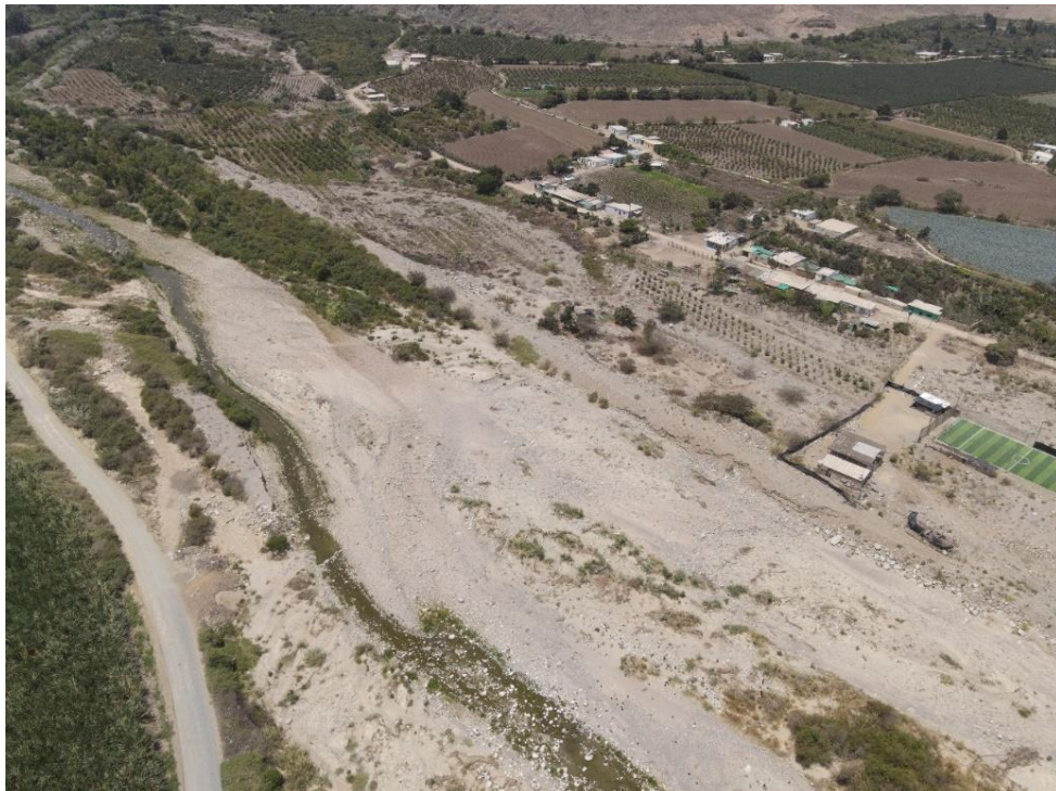
Fotografía 124. Zona crítica 13-070. Viviendas de sector San Juan asentadas en la margen izquierda del río Virú que pueden ser afectadas por erosión fluvial (distrito Virú). Coordenadas UTM: 750640 / 9073585, Zona 17. Tomado el 28-09-2023.
