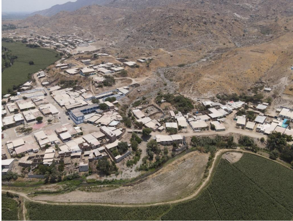
Fotografía 71. Zona crítica 13-039. Viviendas del poblado Huabal asentadas sobre depósitos de flujos de detritos y en desembocadura de quebrada sin nombre (distrito de Chepén). Coordenadas UTM: 685051 / 9193779, Zona 17. Tomado el 25-09-2023.
