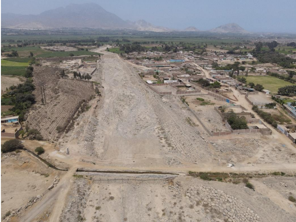
Fotografía 21. Zona crítica 13-009, Vista aguas abajo, se observa canal de riego que cruza la quebrada San Carlos y las barreras compuestas por la acumulación de arenas que podría ser afectado por la erosión fluvial (distrito de Laredo). Coordenadas UTM: 726849 / 9106756, Zona 17. Tomado el 11-09-2023.
