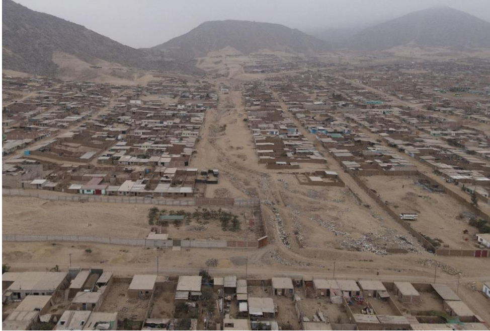
Fotografía 43. Zona crítica 13-022. Cauce de la quebrada Betel que discurre por depósitos eólicos. En sus márgenes se observa viviendas susceptibles a ser afectadas por erosión fluvial y flujos de lodos (distrito de Alto Trujillo). Coordenadas UTM: 719242 / 9110143, Zona 17. Tomado el 12-09-2023.
