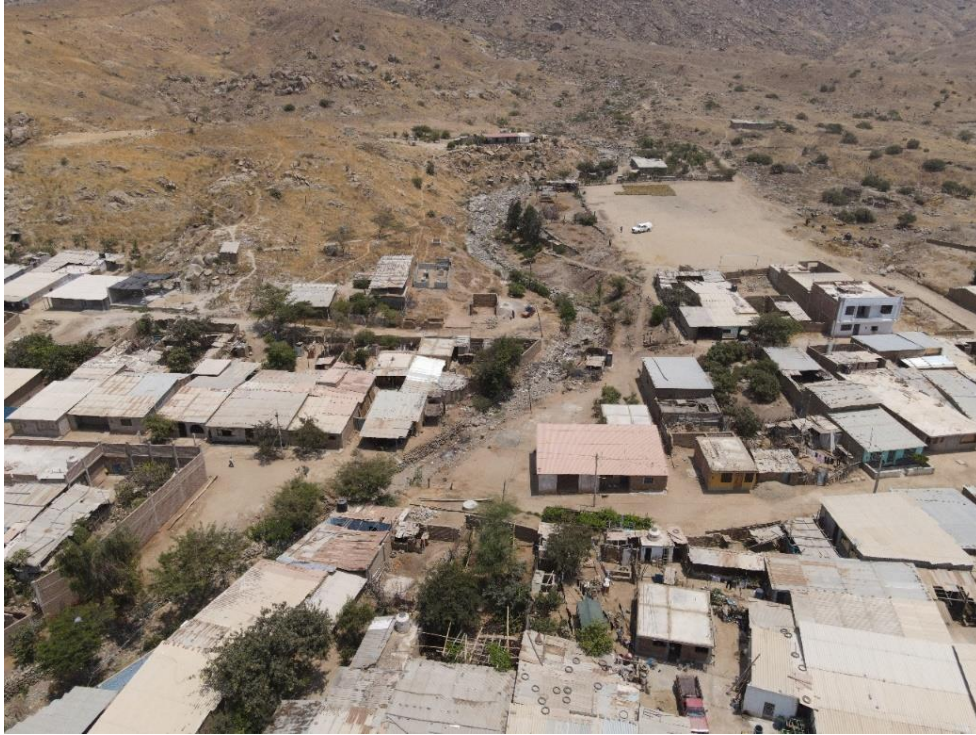
Fotografía 69. Zona crítica 13-038. Viviendas del sector Vichayal asentadas sobre depósitos de flujos de detritos y en desembocadura de quebrada (distrito de Chapén). Coordenadas UTM: 685218 / 9194075, Zona 17. Tomado el 25-09-2023.
