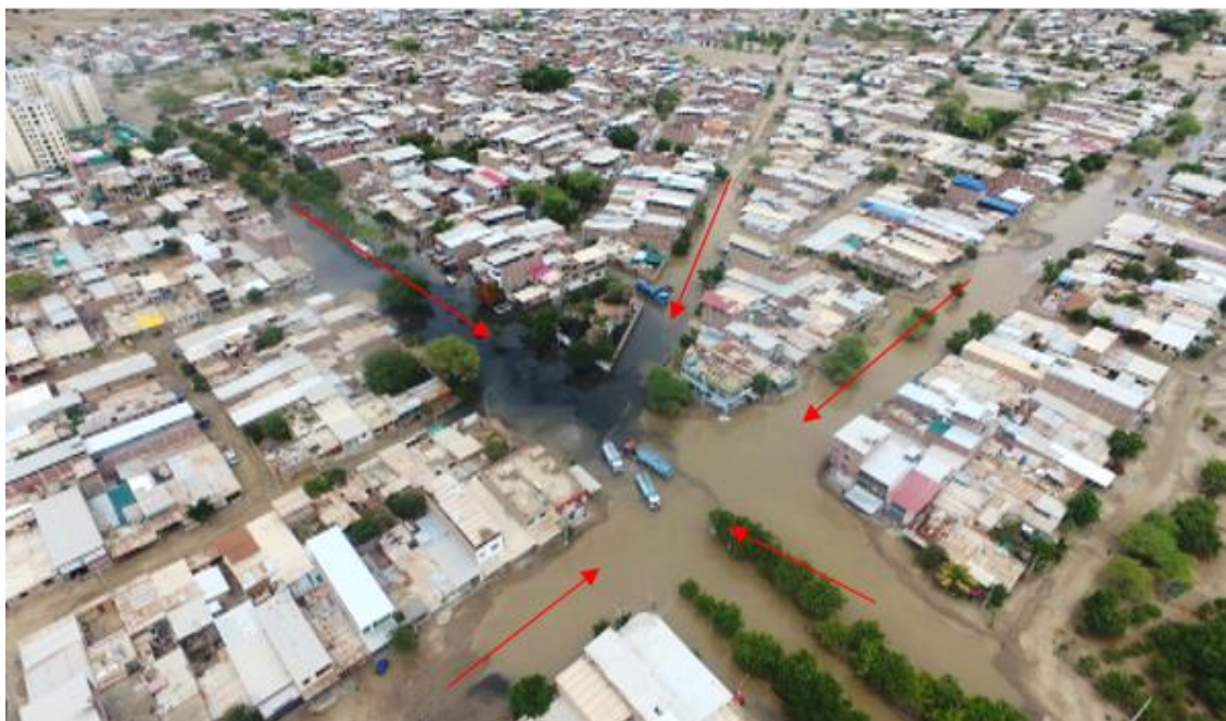
Figura 141. Zona crítica 20-079, Urb. Santa Margarita, Las Dalias, Nestor Martos y Reservorio Lourdes, se delimitan planicies inundables conformadas por depósitos aluviales y principalmente eólicos conformados por arenas, limos y arcillas en capas horizontales y conglomerados. Además, de superficies topográficas con depresiones donde el agua de escorrentía se acumula en temporada de lluvias. Actualmente, estas superficies se encuentran antropizadas que fueron rellenadas con materiales de escombros o botaderos para el emplazamiento de viviendas. (N: 9429118, E: 537790, 15/09/23).
