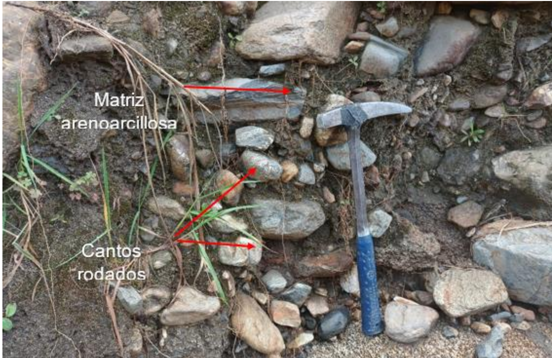
Figura 13. Depósito fluvial donde se puede apreciar la dirección del río por la posición de los cantos son de tamaño variable y de matriz aren arcillosa. Coordenadas: E: 627251; N: 9442617 (04/10/2023).
