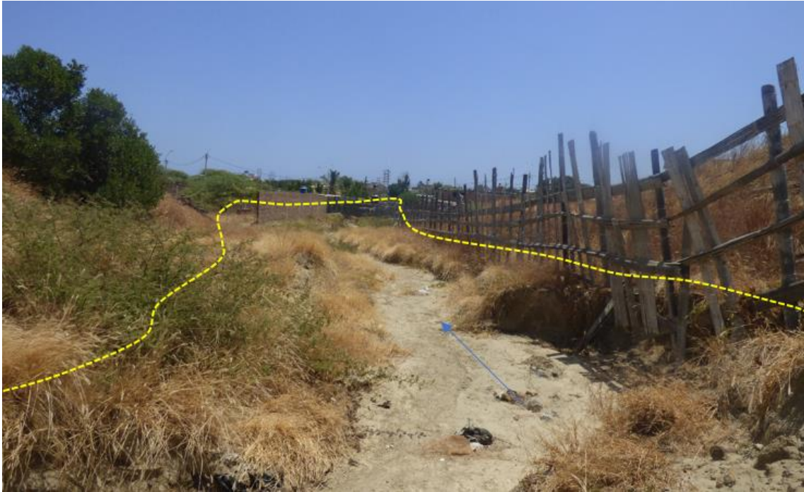
Figura 64. Zona crítica 20-005. Sector Peña Quiroga sujeto a flujos de lodo. El cauce de la quebrada presenta material suelto de arenas y limos. Aguas abajo, en el cauce se tienen viviendas, que obstruyen el paso del flujo. (N: 9539008, E: 486981, 29/08/2023).
