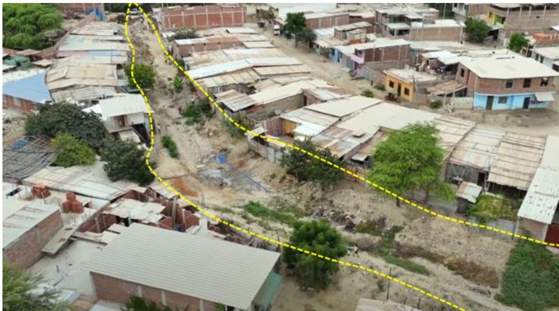
Figura 139. Zona crítica 20-077. Vista hacia el A.H. Sagrado Corazón, sector que fue afectado en el año 2017 y durante el Yacu del presente año por el pazo de un flujo proveniente de la quebrada El Gallo. El flujo recorre las Urb. Cossio del Pomar, A.H. Tacalá, A.H. Sagrado Corazón, se registraron daños en viviendas e infraestructura. (N: 9426480, E: 544559, 15/09/23).
