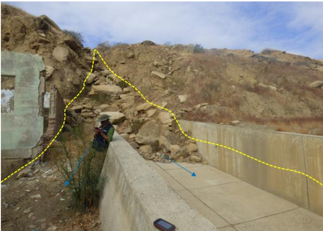
Figura 67. Zona crítica 20-008. Cabo Blanco Zona Norte, sujeta a flujos de detritos y lodo. En el cauce de la quebrada se presenta material suelto conformados por gravillas, arenas y limos con clastos y bloques con tamaños hasta de 20 m de composición areniscosa. (N: 9530136, E: 474604, 29/08/2023).
