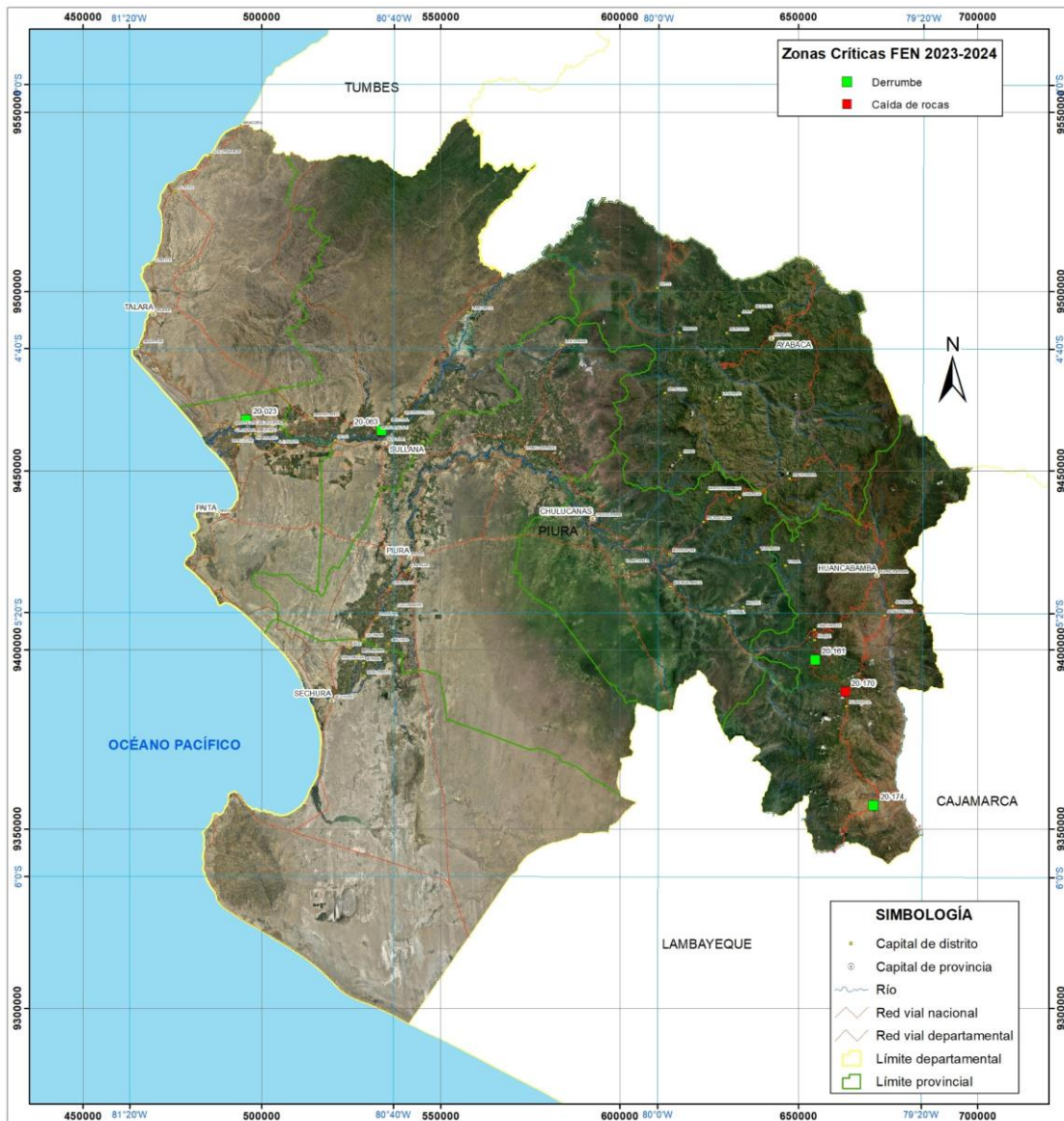
Figura 31. Distribución de las zonas críticas por derrumbes y caída de rocas ante el FEN 2023-2024.
