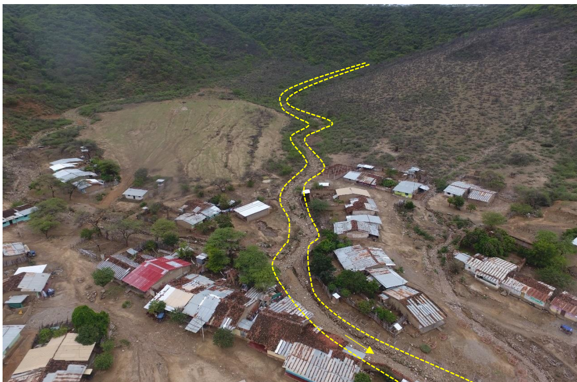
Figura 206. Zona crítica 20-144 Se identificó un flujo de detritos que desciende por la quebrada El Ingenio que se activó en el año 2017 con un tirante de 1 m de altura. Además, se han cartografiado cárcavas que erosionan las laderas arrastrando materiales a la quebrada. (N: 9424297, E: 617308, 17/09/23).
