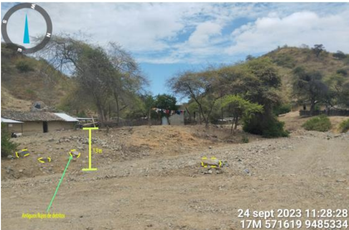
Figura 118. Zona crítica 20-058. Se encuentran viviendas en la intersección de las quebradas Cachis y Pichones, que pueden ser afectadas por erosión fluvial. Se aprecian alrededor de 8 viviendas que se encuentran a 6 m del cauce máximo del río Chipillico.
