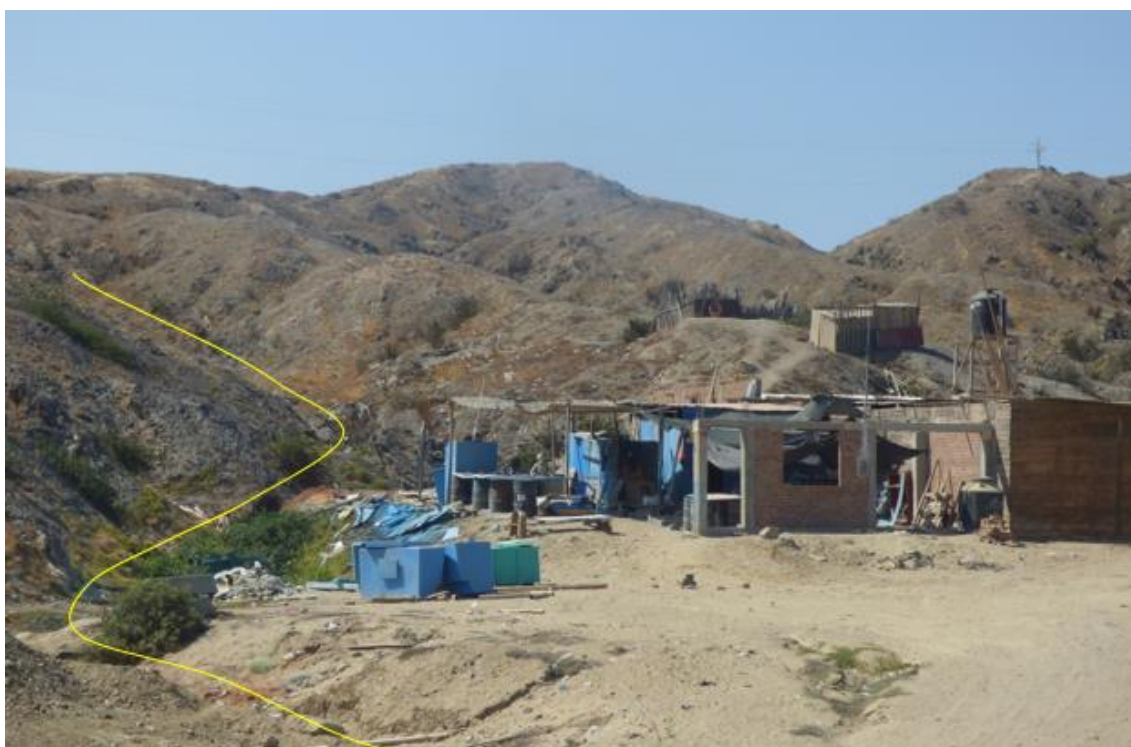
Figura 102. Zona crítica 20-043. C.P. La Islilla, se encuentra afectado por flujos provenientes de una intensa erosión de laderas. Muchos flujos descienden y afectan múltiples viviendas. Además, la vía que conecta con la ciudad de Paita es cortado de manera excepcional por flujo de detritos que interrumpen el tránsito durante eventos del fenómeno de El Niño y/o lluvias excepcionales. (N: 9424071, E: 478658, 09/09/2023).
